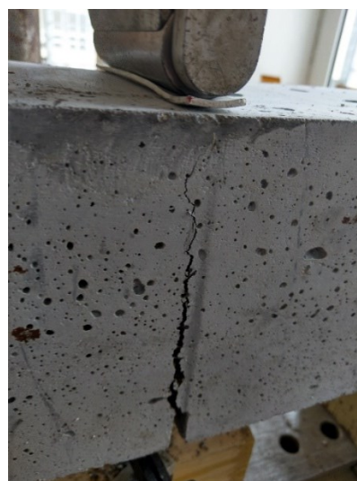
Obrázok 22 Trhlina po trojbodovej ohybovej skúške drátkobetónového trámca [autor]
