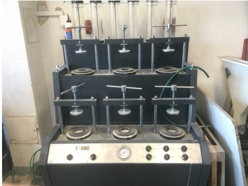
Obrázok 14 Zariadenie určené na skúšku hĺbky priesaku tlakovou vodou [autor]
