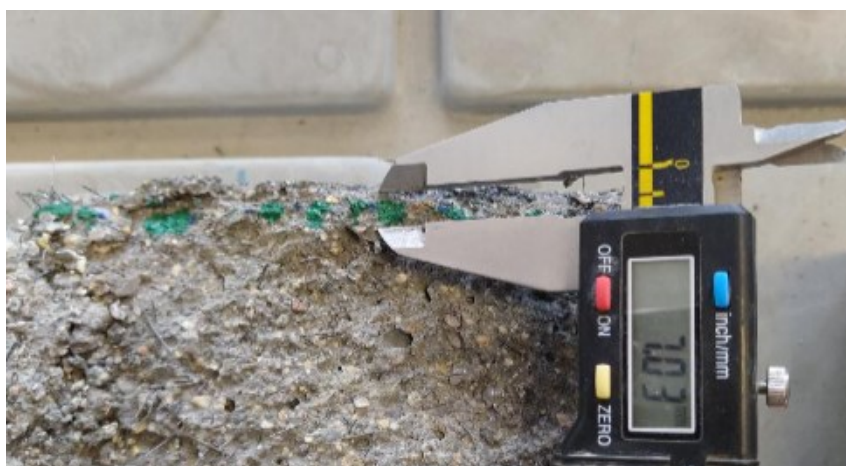
Obrázok 34 Meranie hĺbky priesaku na drátkobetónovej vzorke [autor]
