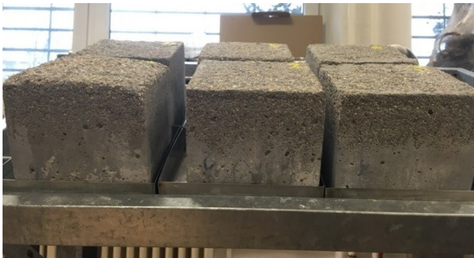
Obrázok 31 Vzorky prostého betónu (horný rad) a drátkobetónu (spodný rad) po skúške odolnosti voči mrazu a CHRL [autor]
