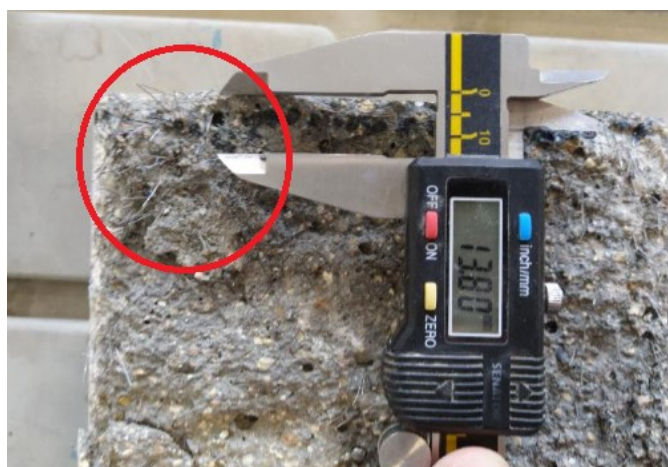
Obrázok 35 Maximálna hĺbka priesaku na drátkobetónovej vzorke v oblasti so zvýšenou koncentráciou drôtikov [autor]
