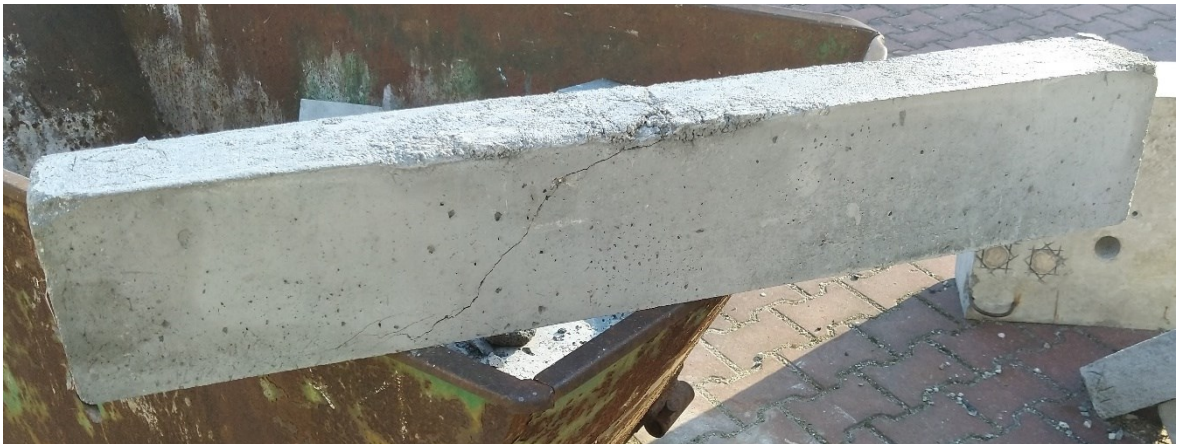
Obrázok 29 Porušený trámec s rozmermi 190 x 100 x 1150 mm s betonárskou výstužou a dávkovaním drôťkov 60 \text{ kg}/\text{m}^3 po trojbodovej ohybovej skúške s viditeľnou šmykovou trhlinou [autor]
