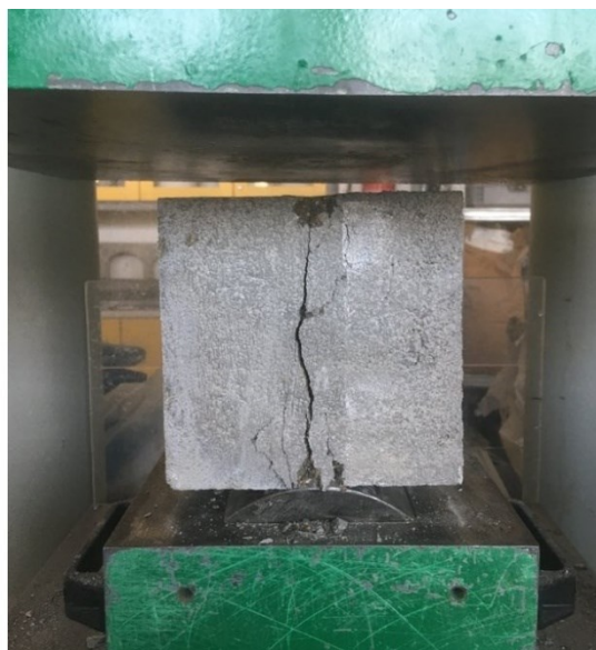
Obrázok 19 Vzorka drátkobetónu po skúške pevnosti v priečnom ťahu [autor]
