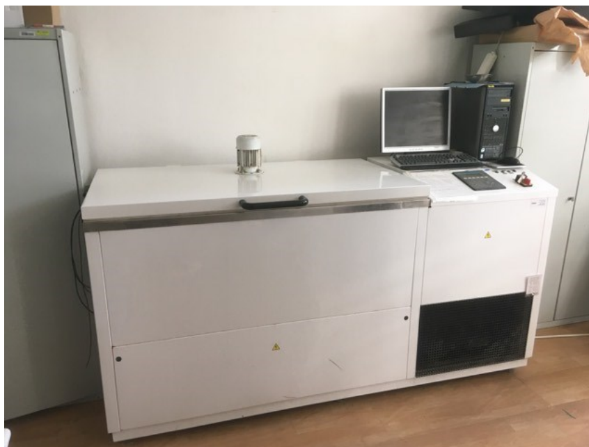
Obrázok 13 Mraziak určený na skúšku odolnosti voči mrazu a CHRL [autor]
