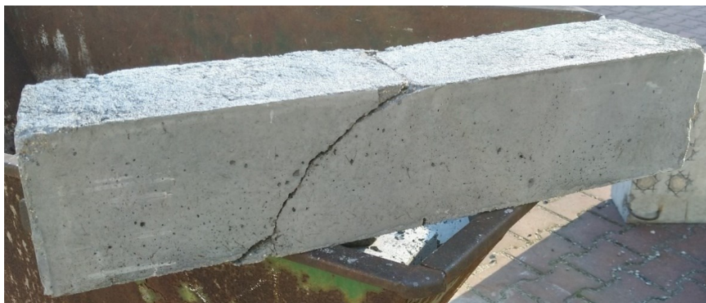
Obrázok 27 Vzorka porušeného drátkobetónového trámca s betonárskou výstužou s rozmermi 150 x 150 x 700 mm po trojbodovej ohybovej skúške; na fotke viditeľná šmyková trhlinka [autor]
