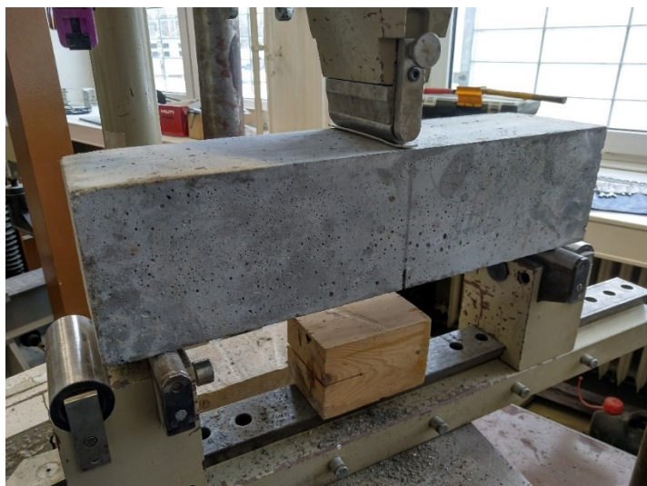
Obrázok 21 Trojbodová ohybová skúška drátkobetónového trámca s viditeľným zárezom 25 mm v strede trámca [autor]
