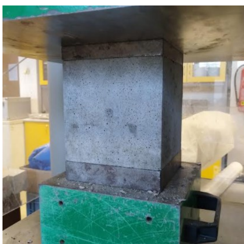
Obrázok 17 Skúška pevnosti v tlaku drátkobetónovej kocky v hydraulickom lise [autor]
