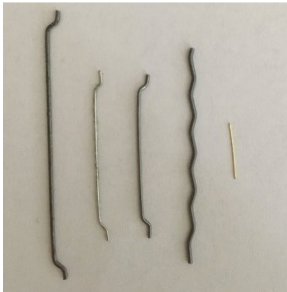
Obrázok 39 Použité ocelové vlákna (zľava doprava) – Dramix 3D 65/60 BG, Dramix 3D 65/35 GG, Dramix 3D 45/35 BL, Tabix 1/45, MasterFiber 482 [autor]
