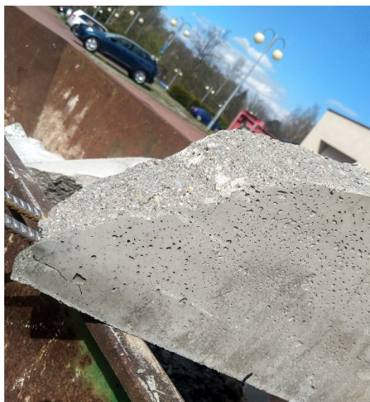
Obrázek 18: Nosník délky 1150 mm a průřezu 190x100 mm, výztuž 2x8 mm, rozpětí 900 mm, porušení smykem, zdroj vlastní
