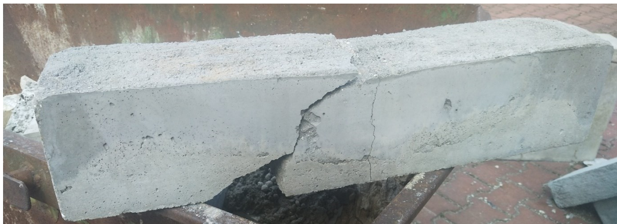
Obrázek 15: Nosník délky 700 mm a průřezu 150x150 mm, výztuž 2x6 mm, rozpětí 600 mm, porušení tahem + smykem, zdroj: vlastní
