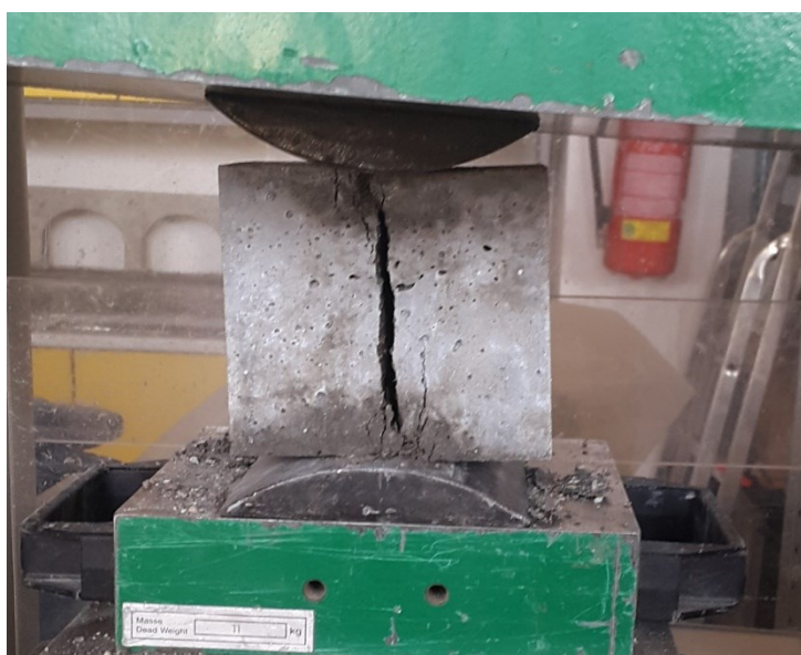
Obrázek 9: Zkušební krychle 150x150x150 mm během zkoušky v příčném tahu, zdroj vlastní
