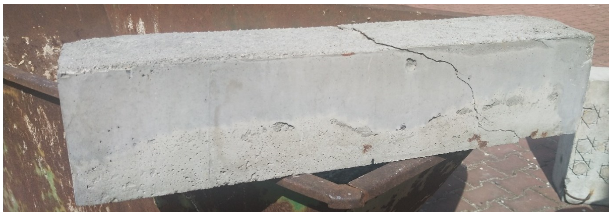
Obrázek 17: Nosník délky 900 mm a průřezu 150x150 mm, výztuž 2x8 mm, rozpětí 600 mm, porušení smykem, zdroj vlastní
