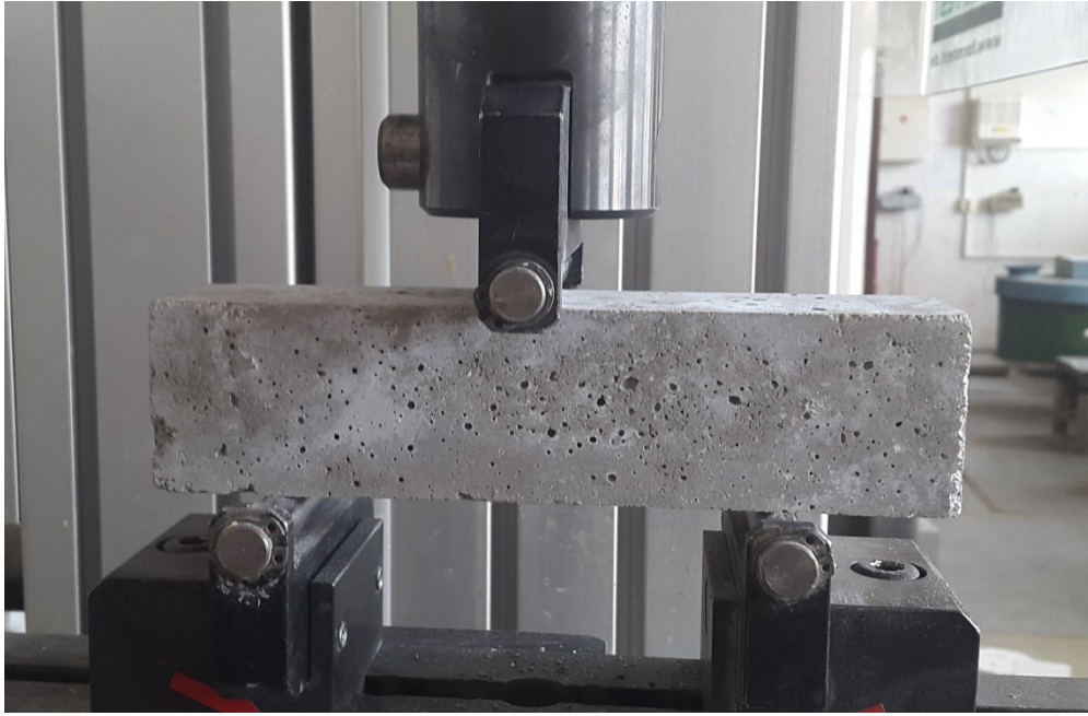
Obrázek 10: Zkouška v tlaku za ohybu trámce 160x40x40 mm, zdroj: vlastní
