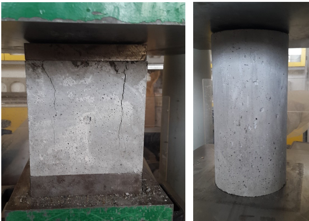
Obrázek 8: Zkušební vzorky krychle 150x150x150 mm a válec 300x150 během zkoušky v tlaku, zdroj: vlastní
