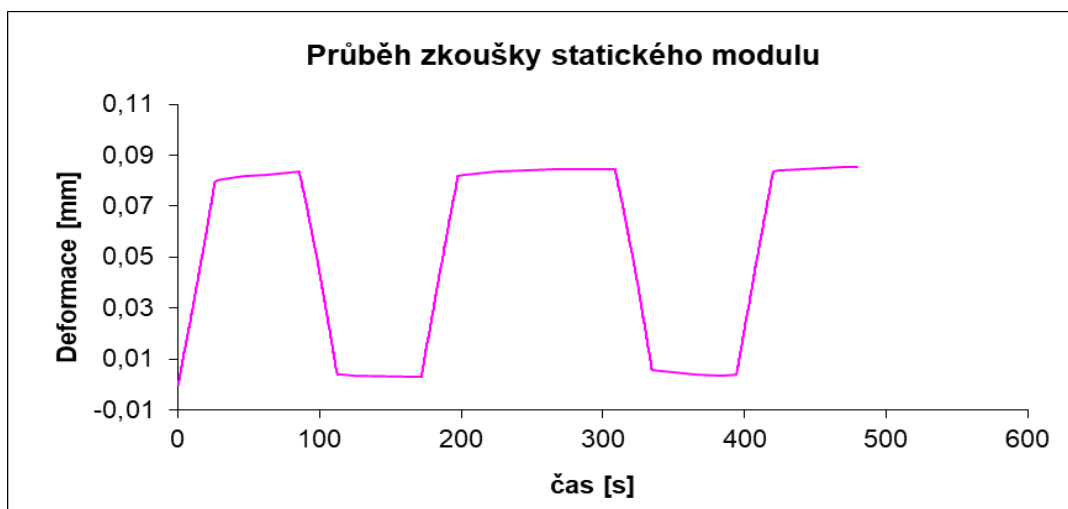
Graf 14: Typický průběh deformace v závislosti na čase během zkoušky statického modulu pružnosti
