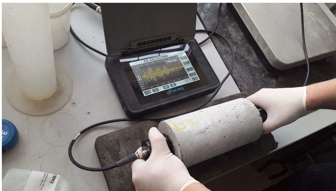
Obrázek 14: Měření ultrazvukovou impulzivní metodou, zdroj: vlastní
