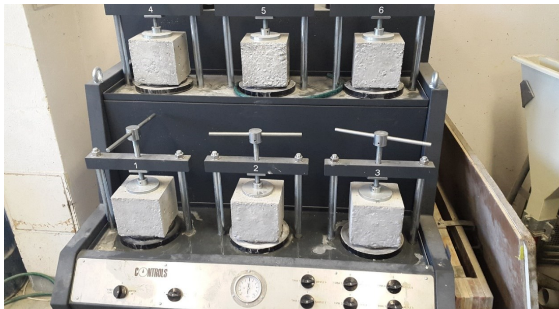
Obrázek 5: Přístroj na zkoušku průsaku tlakovou vodou, zdroj: vlastní
