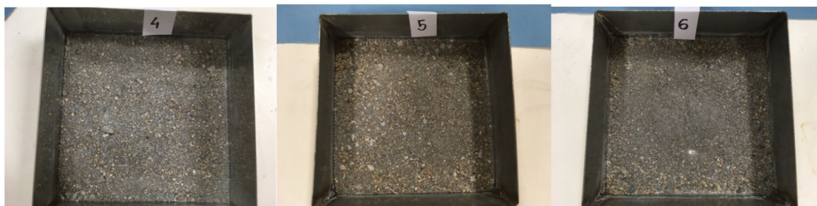
Obrázek 12: Odpad vzniklý po 100 odolnosti proti CHRL, zdroj: vlastní
