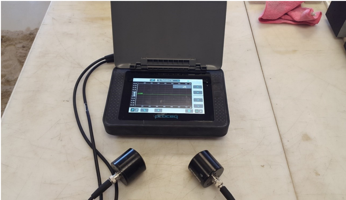
Obrázek 6: Přístroj pro měření ultrazvukovou metodou, zdroj: vlastní
