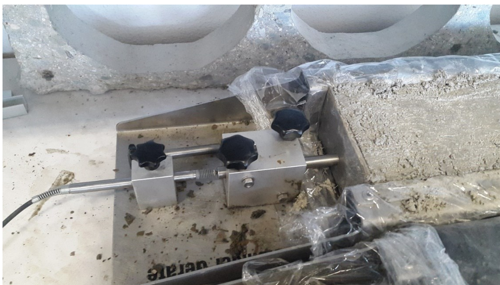
Obrázek 7: Zkušební žlab značky Schleibinger v místě připojení sondy, zdroj: vlastní
