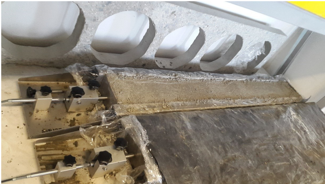
Obrázek 13: Probíhající zkouška objemových změn, zdroj: vlastní
