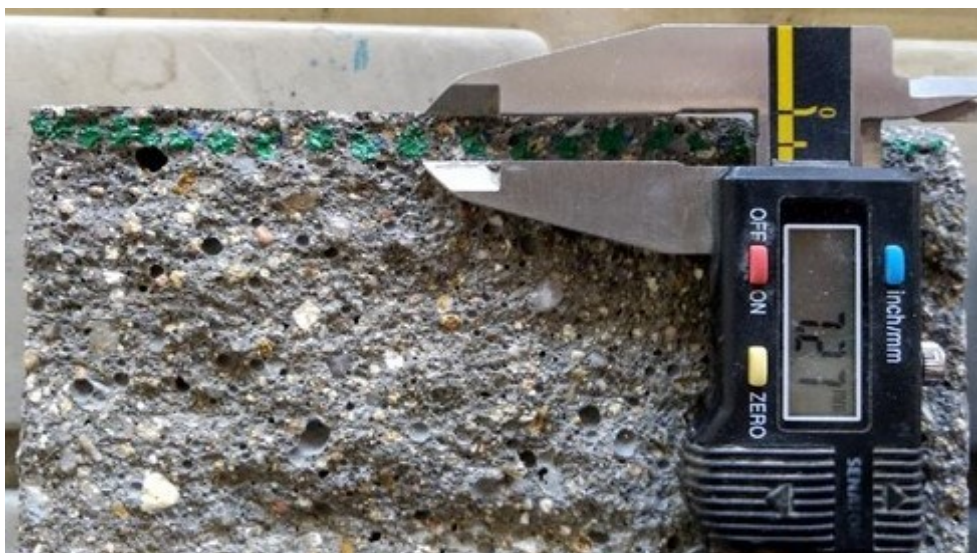
Obrázek 11: Maximální hloubka průsaku, zdroj: vlastní
