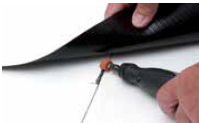
Obrázek 20 - Čištění pomocí frézky [25]
