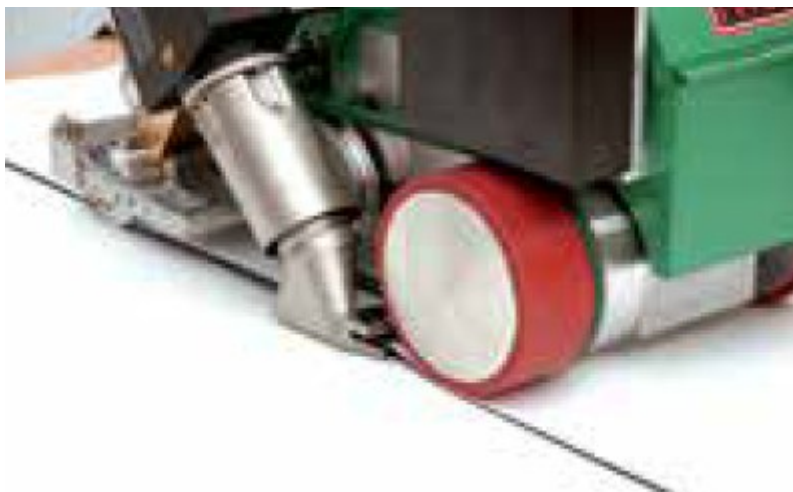
Obrázek 19 - Ukázka svařování pomocí svařovacího automatu [25]
