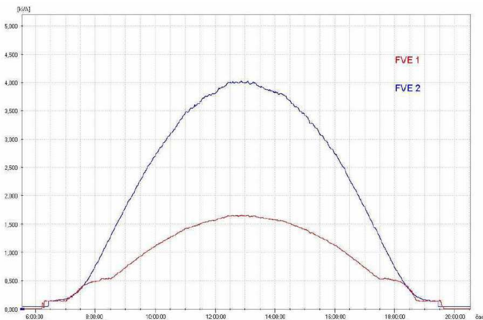
Obr. 25 Fotovoltaická elektrárna: Průběh výkonu dodávaného elektrárnou za slunečného dne, pro navrhovanou elektrárnu je platná křivka FVE2 modré barvy. [10].
