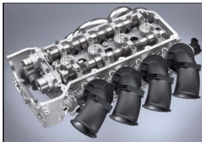
Obr.č.13 - Hlava válce s vačkovými hřídelemi a sacími trubkami [26]
