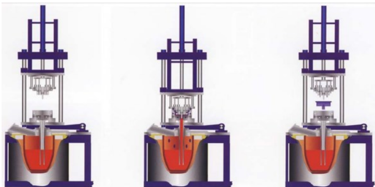
Obrázek 8 – Princip a pracovní postup výroby odlitků nízkotlakým litím [36]
