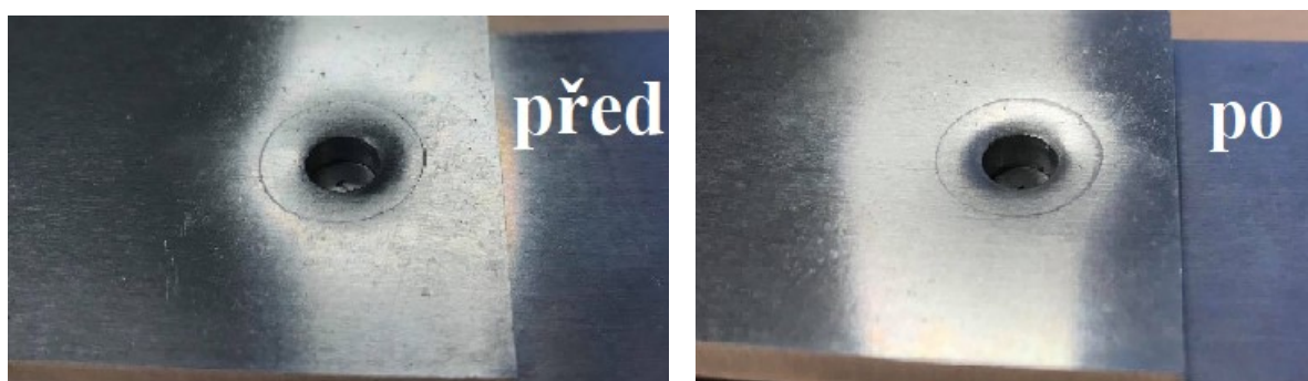
Obr. 36 Porovnání čtvrté sady před a po zkoušce na trhacím stroji
