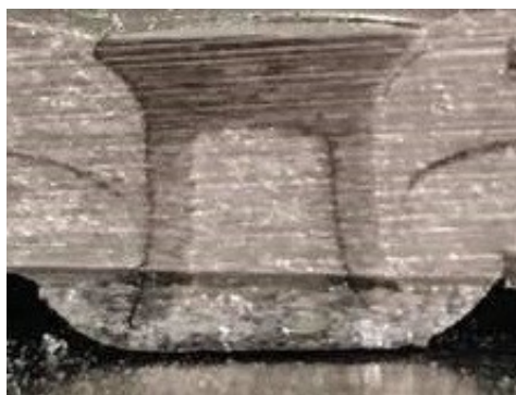
Obr. 28 Řez spojem nýtovaným parametry 55 kN, 1 mm/s
