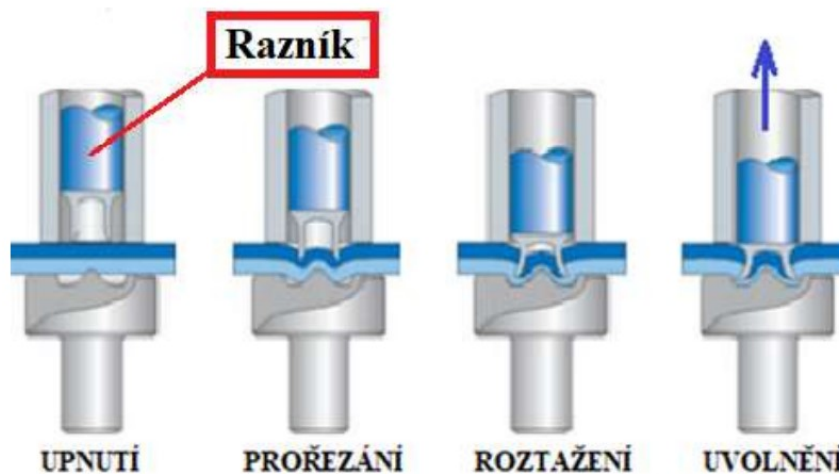
Obr. 4 Proces self-piercing nýtování. Dostupné z [4]
