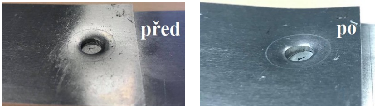
Obr. 33 Porovnání třetí sady před a po zkoušce na trhacím stroji
