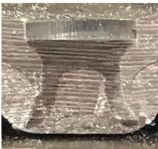
Obr. 34 Řez spojem nýtovaným parametry 55 kN, 40 mm/s
