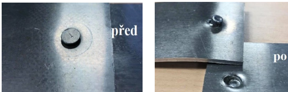
Obr. 43 Porovnání šesté sady před a po zkoušce na trhacím stroji
