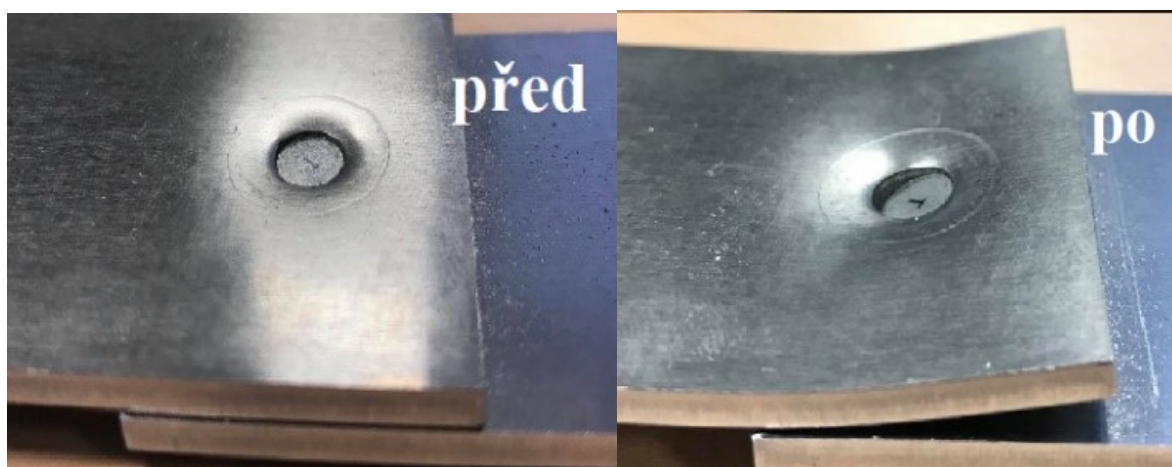
Obr. 30 Porovnání druhé sady před a po zkoušce na trhacím stroji
