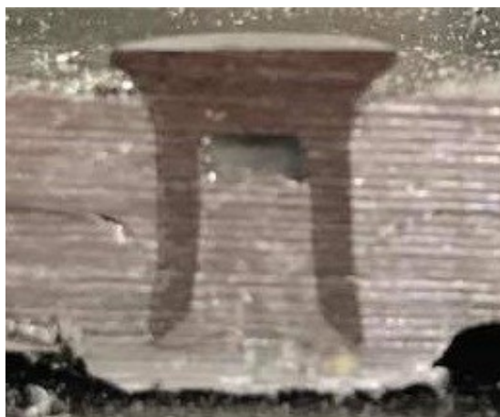
Obr. 44 Řez spojem nýtovaným parametry 15 kN, 25 mm/s
