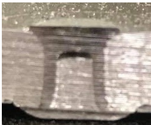
Obr. 47 Řez spojem nýtovaným parametry 15 kN, 35 mm/s
