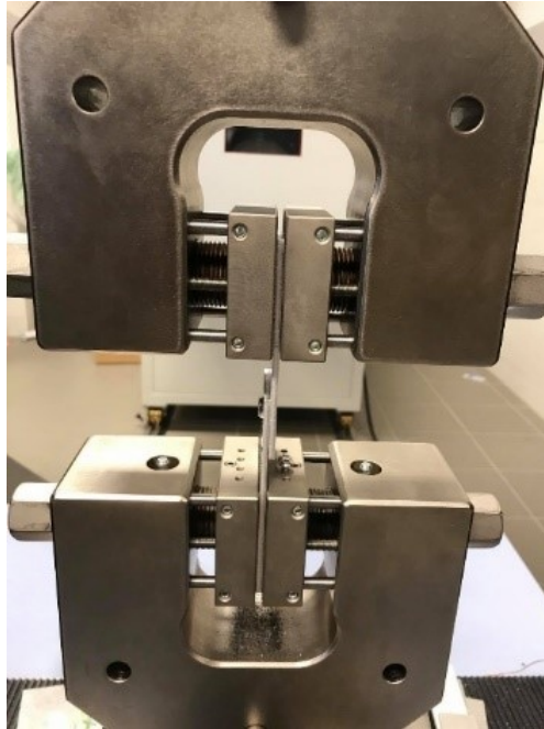
Obr. 22 Upevnění vzorku do čelistí na trhacím stroji
