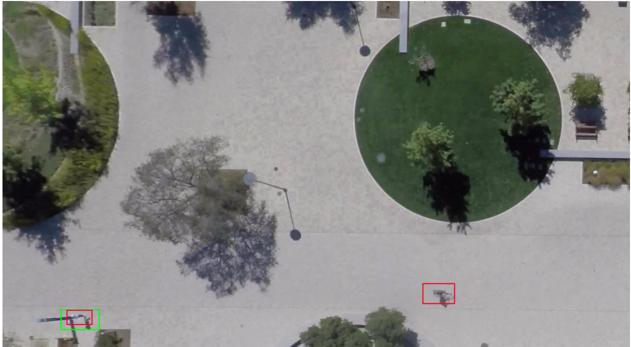
Obr. 5.2: Výsledok detekcie po druhom tréningu. Anotácie sú vyznačené zelenou farbou, červenou farbou sú označené detekcie.
