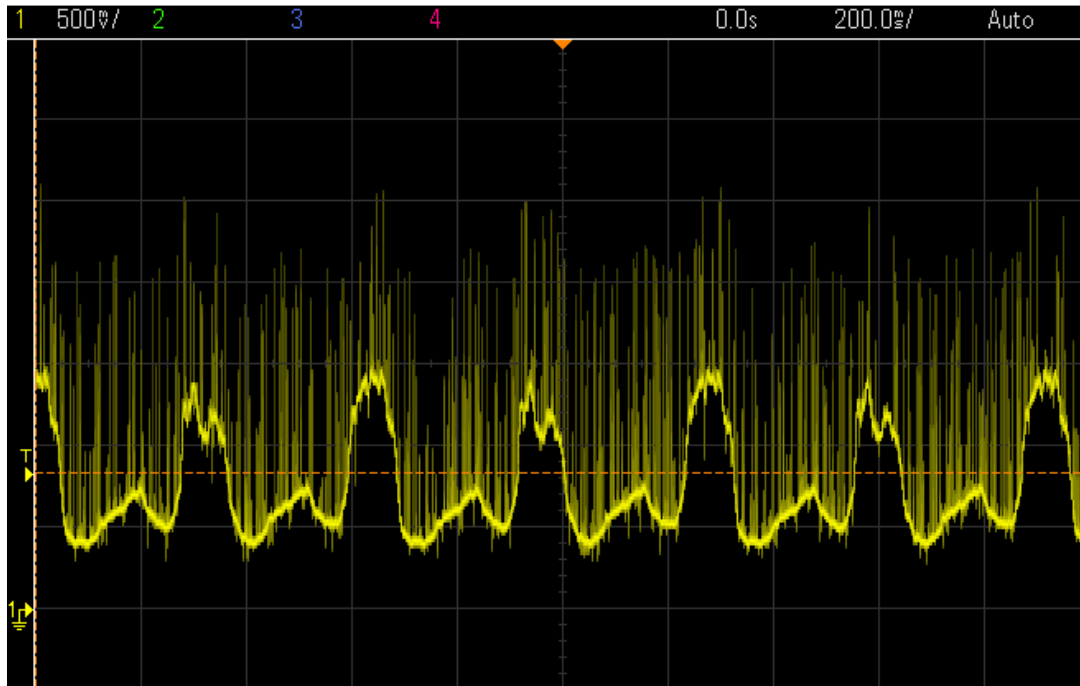
Obrázek 21. - Naměřený výstupní signál senzoru otáček pomocí osciloskopu
