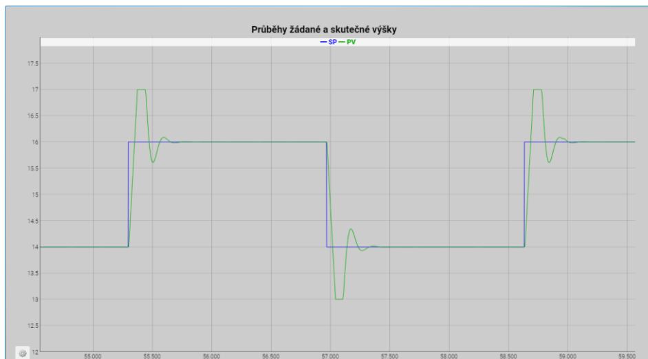
Obrázek 24: Průběh žádané a skutečné výšky a akčního zásahu v SIL simulátoru – MIL regulátor
