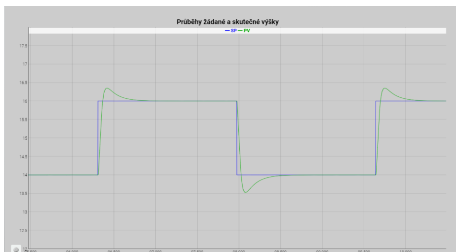
Obrázek 25: Průběh žádané a skutečné výšky a akčního zásahu v SIL simulátoru – ruční regulátor
