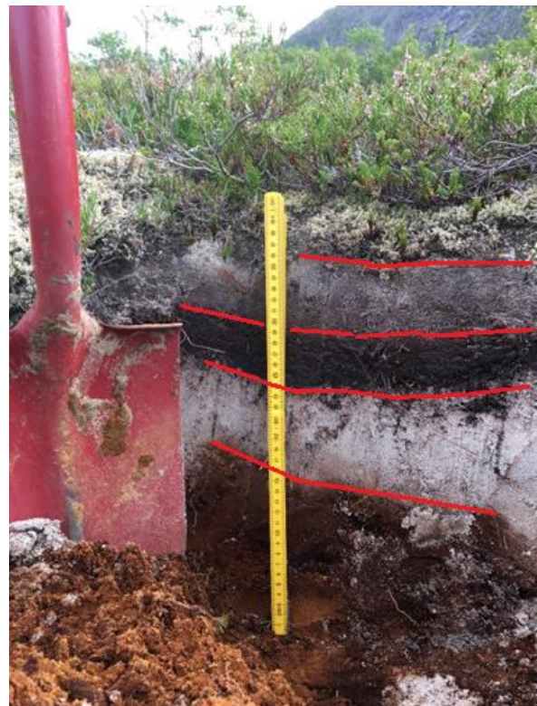
Figur 5.19: Viser snittet gravd ved lokalitet 9. Snittet har et klassisk podsolprofil med bleikjordssjikt og aurhelle under et lag med paleosol. Lagene er skilt fra hverandre med røde streker. Avsetningene er eoliske.
