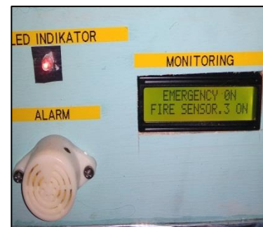
Gambar 4.8 : Pengujian ruang 3 menggunakan media api lilin
