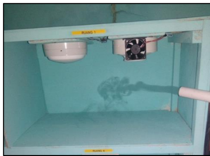
Gambar 4.2 : Pengujian ruang 1 memberikan asap
