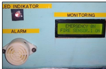
Gambar 4.2 : Pengujian ruang 1 memberikan asap
