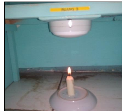
Gambar 4.8 : Pengujian ruang 3 menggunakan media api lilin
