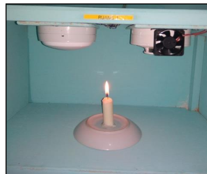
Gambar 4.6 : Pengujian ruang 1 menggunakan media api lilin
