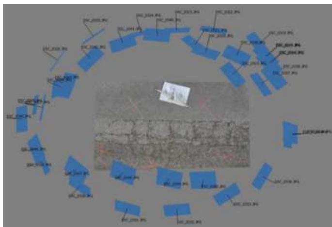
Fig. 1 - Esempio di un dataset fotografico di un degrado sulla pavimentazione di una sezione stradale. (fonte: propria elaborazione)
