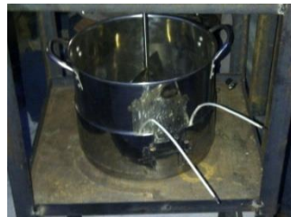
Gambar 7 Keterpasangan elemen pemanas dengan bejana aduk
