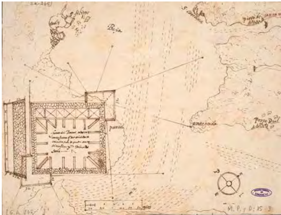
Figura 2. Plano del Fuerte del Puntal en la bahía de Cádiz, con indicación de las obras que debían hacerse en él para su mejor defensa, 1589.
