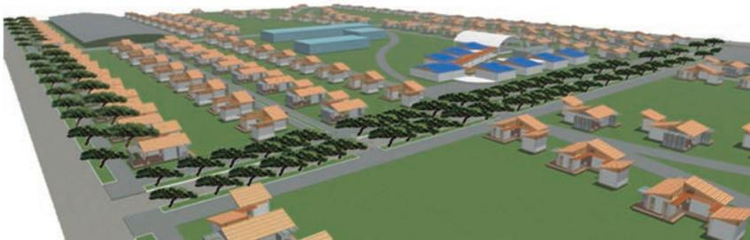
Los materiales empleados son los del lugar, se aprovecha el tipo de suelo existente; muros en bloques de tierra cemento, pisos en cemento afinado, cubierta en teja de barro sobre estructura de madera, cerramiento de algunos espacios con yotojoro (enramada y cocina).
