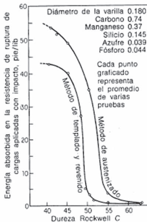
Fig. 5. COMPARACIÓN ENTRE EL MÉTODO DE AUSTENIZADO Y EL DE TEMPLADO Y REVENIDO PARA UN ACERO [21]
