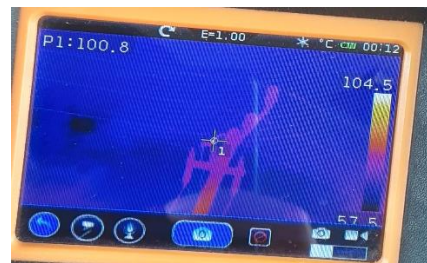
Gambar 4. Pengukuran Suhu titik sambungan jenis Paralel Groove pada Penyulang Rantepao
