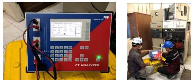
Gambar 10. Pengujian CT dan PT
