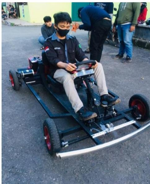
Gambar 10. Pengujian Motor Dijalan Menggunakan Beban
