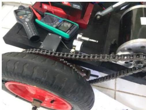
Gambar 8. Pengujian Motor Berbeban
