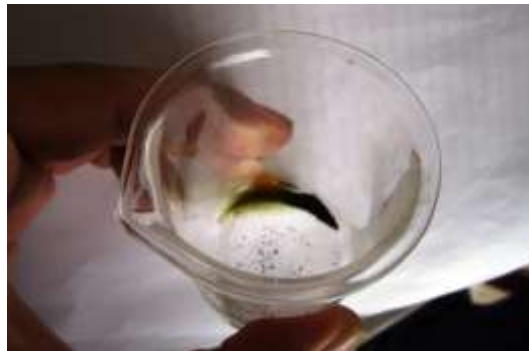
Figura 99: Reacción del ácido nítrico con la escoria de cobre.
