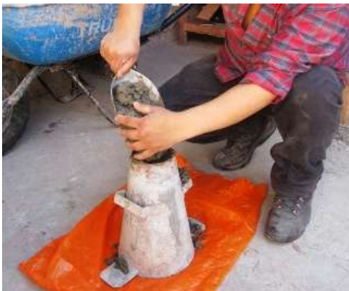
Figura 50: Colocación de mezcla en el cono de Abrams.
