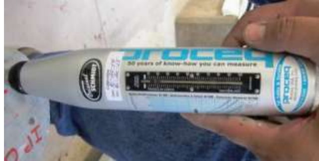
Figura 13: Esclerómetro analógico marca Proceq.
