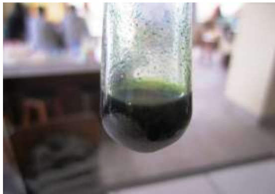
Figura 100: Reacción del ferricianuro de potasio con la escoria de cobre.
