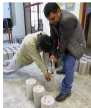
Figura 59: Ensayo de índice de rebote sobre probetas de concreto.
