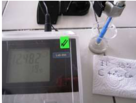
Figura 103: Medición del pH del concreto con 35% de escoria de cobre.
