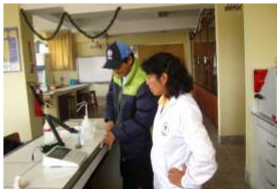
Figura 66: Medición del pH del concreto con escoria de cobre.
