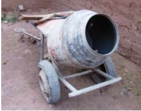
Figura 8: Mezcladora de media bolsa de cemento de capacidad.
