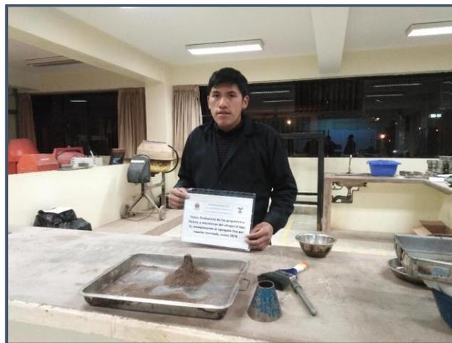
*Figura 37: Determinación de condición superficialmente seca del agregado fino por el tesista*
