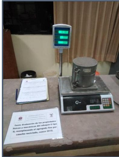
*Figura 51: Registro del peso de agregado más molde para ensayo de peso unitario*
