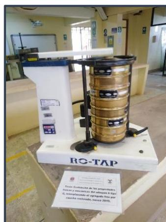
Figura 29: Tamizadora mecánica para agregados
