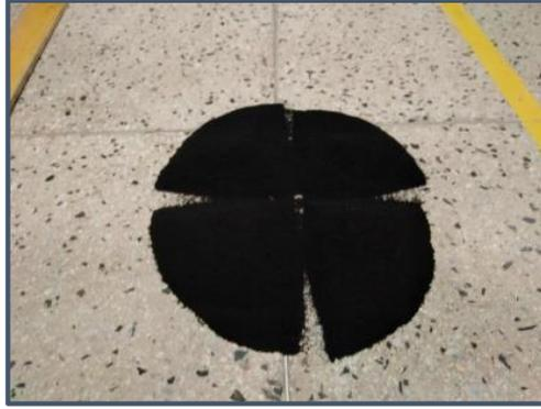
*Figura 33: Cuarteo de caucho reciclado fino*
