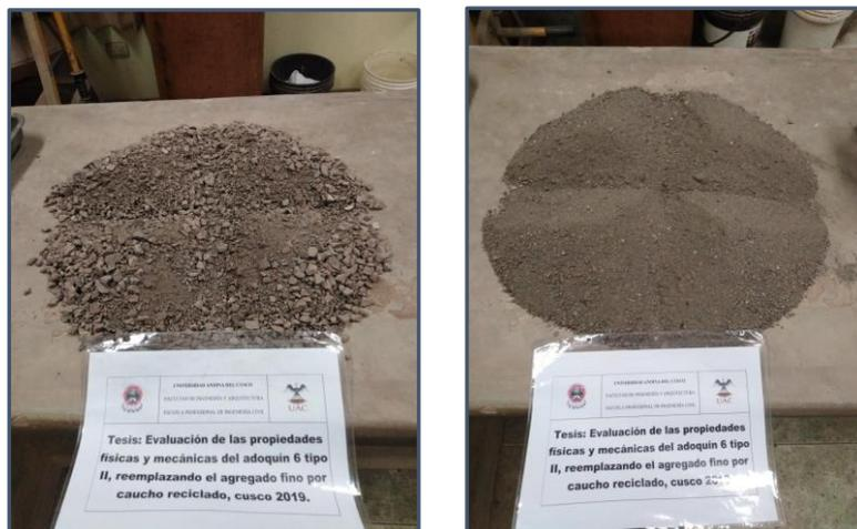
Figura 46: Selección de agregados gruesos y finos para ensayo de peso unitario
