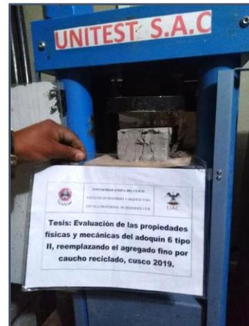
*Figura 80: Adoquines colocados en máquina para ensayo de resistencia a compresión*
