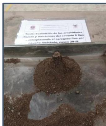
*Figura 38: Agregado fino en condición superficialmente seca*
