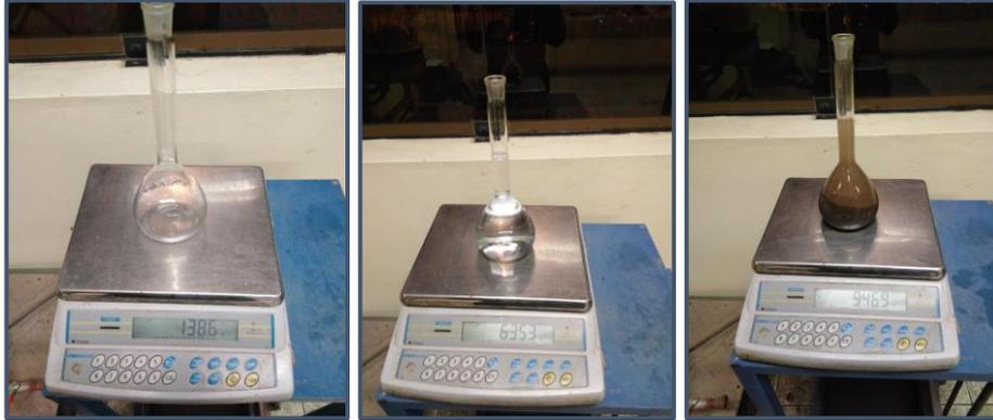
*Figura 39: Picnómetro en procedimientos de ensayo*
