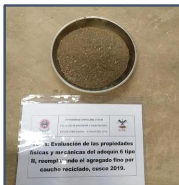
*Figura 35: Selección de agregado fino para ensayo de Peso específico*
