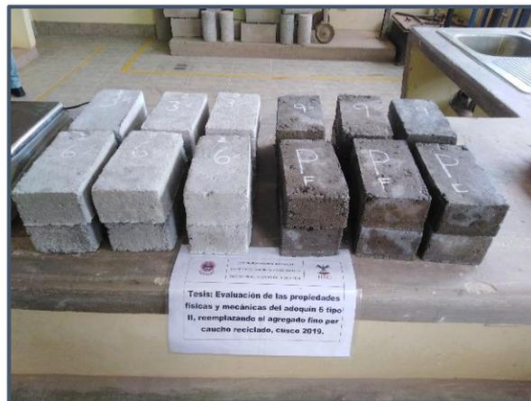
Figura 75: Adoquines secos y superficialmente secos
