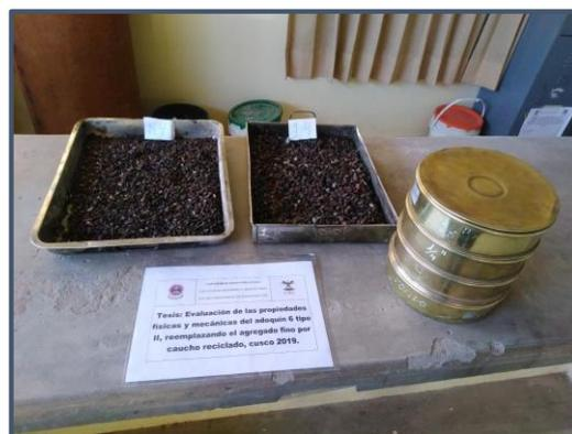
Figura 55: Agregado lavado después de ser tamizado para el ensayo de Abrasión los Ángeles
