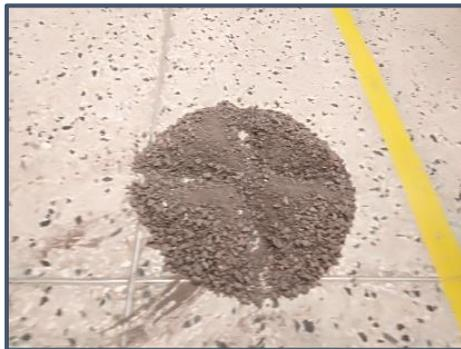
*Figura 22: Cuarteo de agregado grueso*
