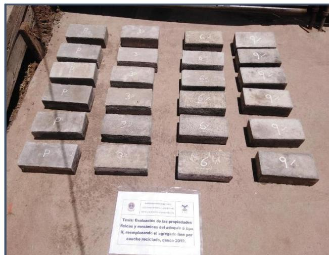
*Figura 68: Adoquines de concreto secos*
