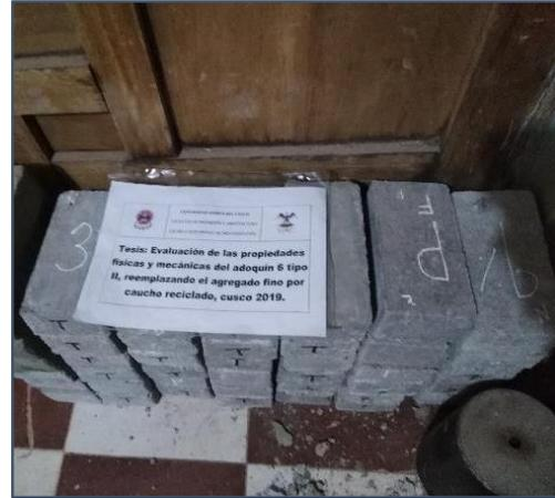
*Figura 79: Adoquines previo al ensayo de resistencia a compresión*
