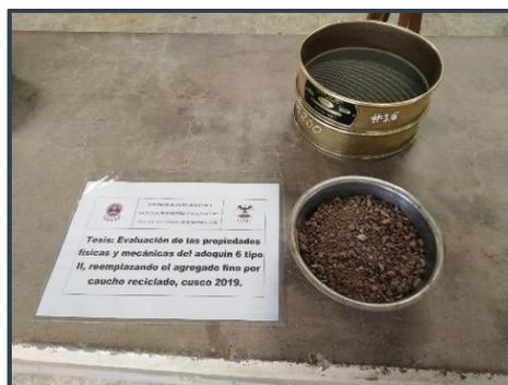
*Figura 25: Materiales de ensayo con agregado para ensayo de Malla N° 200*
