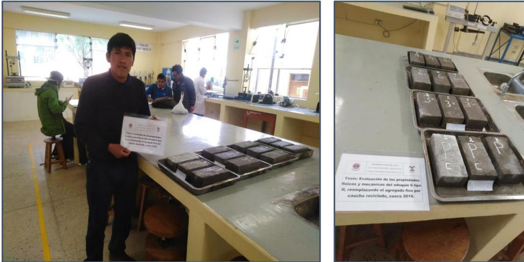
*Figura 73: Adoquines ensayados, saturados superficialmente secos*
