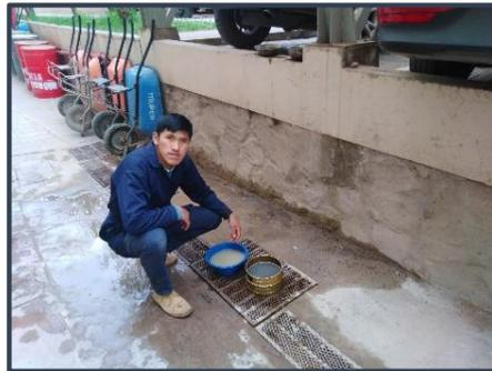
*Figura 27: Lavado de agregados para ensayo de Malla N° 200*
