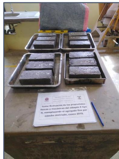
*Figura 77: Adoquines saturados con superficie seca*
