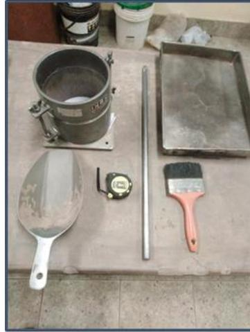
*Figura 47: Equipos para ensayo de peso unitario de agregados*
