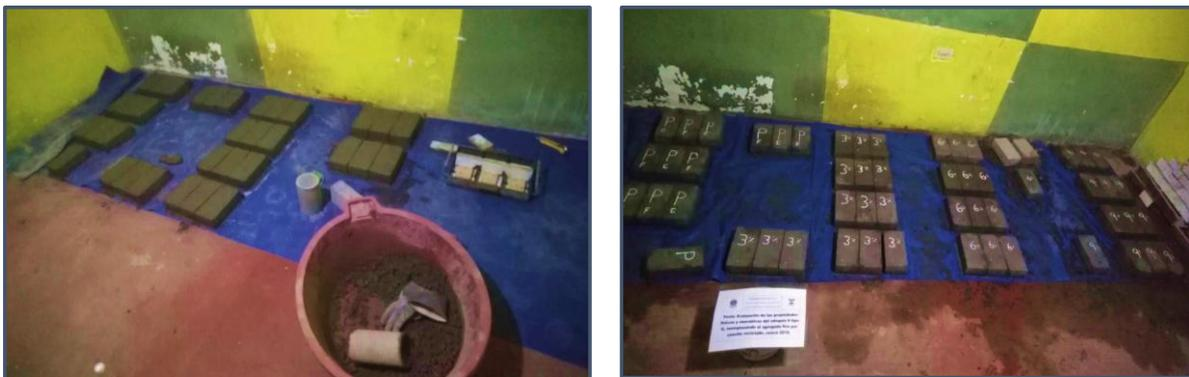
*Figura 65: Adoquines de concreto moldeados e identificados*
