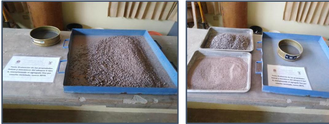
*Figura 58: Agregado tamizado después de proceso de desgaste*
