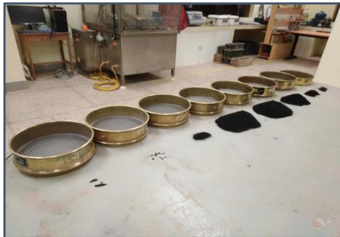
*Figura 34: Granulometría de caucho reciclado fino*
