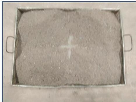
*Figura 53: Cuarteo de agregado fino para ensayo de porcentaje de humedad*
