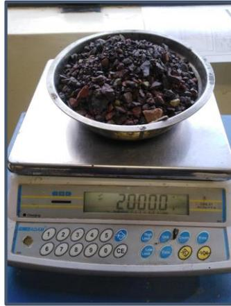
*Figura 54: Registro de agregado grueso para ensayo de porcentaje de humedad*
