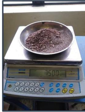
*Figura 26: Registro del peso de agregado para ensayo de Malla N° 200*
