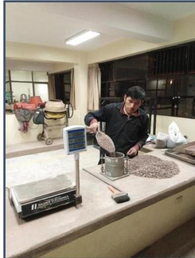
*Figura 49: Procedimiento de ensayo de peso unitario de agregado grueso por tesista*
