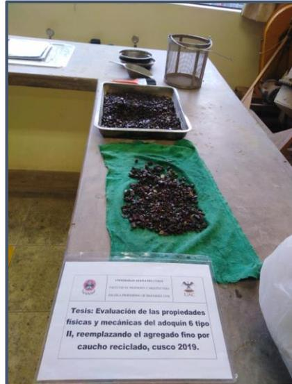
*Figura 44: Procedimiento de secado superficial de agregados gruesos*
