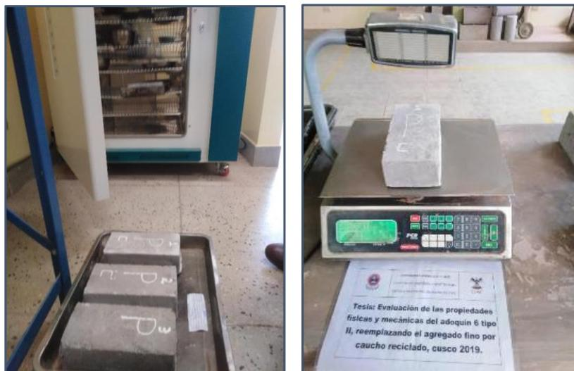
*Figura 74: Adoquines retirados del horno para posteriormente enfriados registrar su peso*
