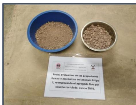
Figura 41: Selección de agregados grueso para ensayo de peso específico
