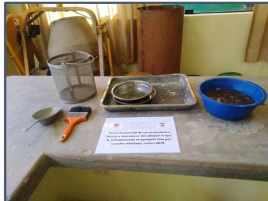
*Figura 43: Equipos y materiales para ensayo de peso específico de agregados gruesos*
