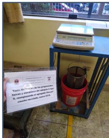
*Figura 45: Registro de peso de agregados gruesos saturados*
