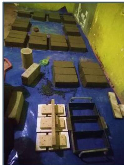
*Figura 64: Moldeado de adoquines con adoquinera manual*
