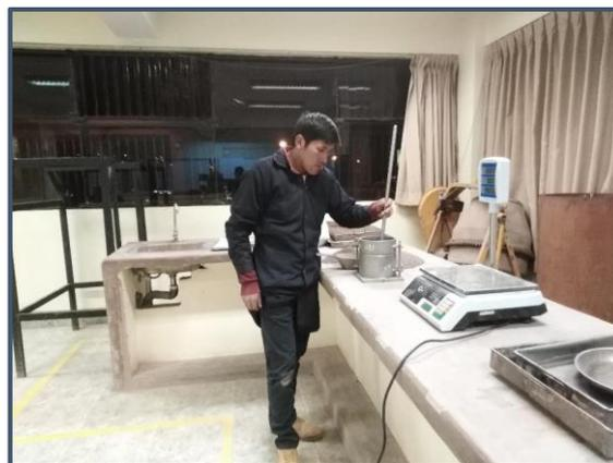
*Figura 50: Procedimiento de varillado para el ensayo de peso unitario por el tesista*
