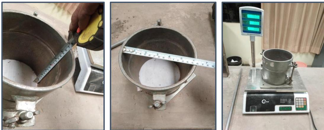
*Figura 52: Registro de dimensiones de molde metálico para ensayo de peso unitario de agregados*
