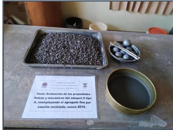
*Figura 56: Agregado secado para colocar a la máquina de los Ángeles*
