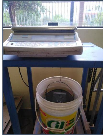
*Figura 76: Sumergido de adoquines para registrar su peso sumergido*
