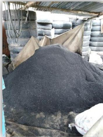
*Figura 16: Caucho triturado producto de neumáticos en desuso*
