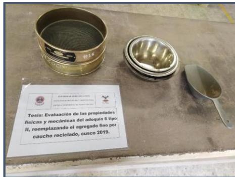
*Figura 24: Materiales de ensayo para ensayo de Malla N° 200*
