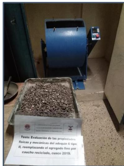
*Figura 57: Máquina de los Ángeles antes del ensayo*
