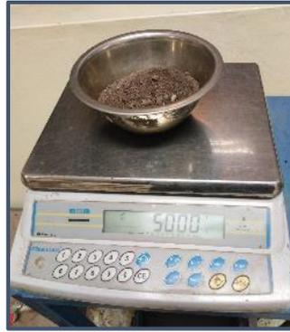
*Figura 36: Registro del peso de agregado fino para Peso específico*
