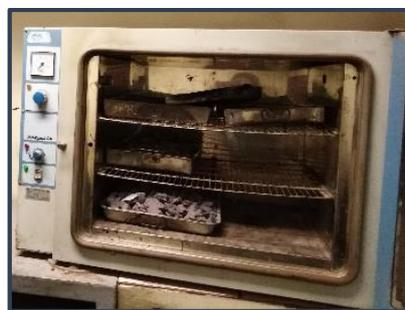
*Figura 28: Horno en proceso de secado de agregados*
