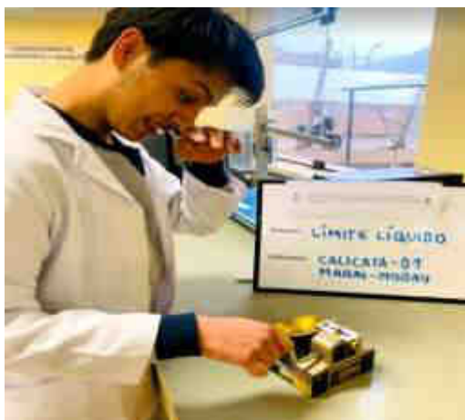
Figura 25a) Superficie horizontal con la cuchara casa grande, b) Registro del número de golpes establecidos
