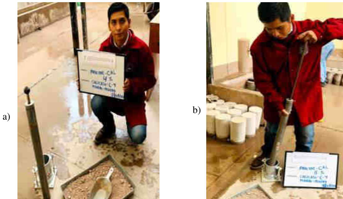
Figura 36: Ensayo de proctor modificado con 4.5% de cal “a)”, Proctor modificado con 5.5% y 6.5% de cal “b)”
