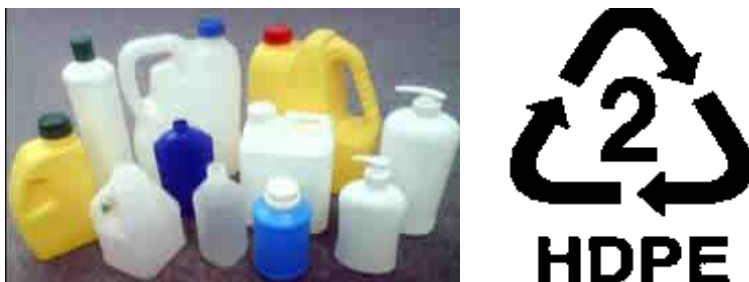
Figura 10: Frasco típico y símbolo de reciclaje (HDPE)
