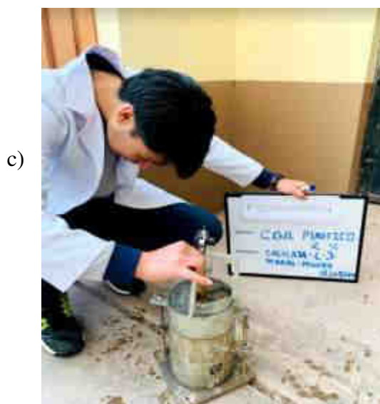
Figura 30: c) Lectura para medir el hinchamiento colocando el trípode, d) Medición del dial para medir la penetración del pistón
