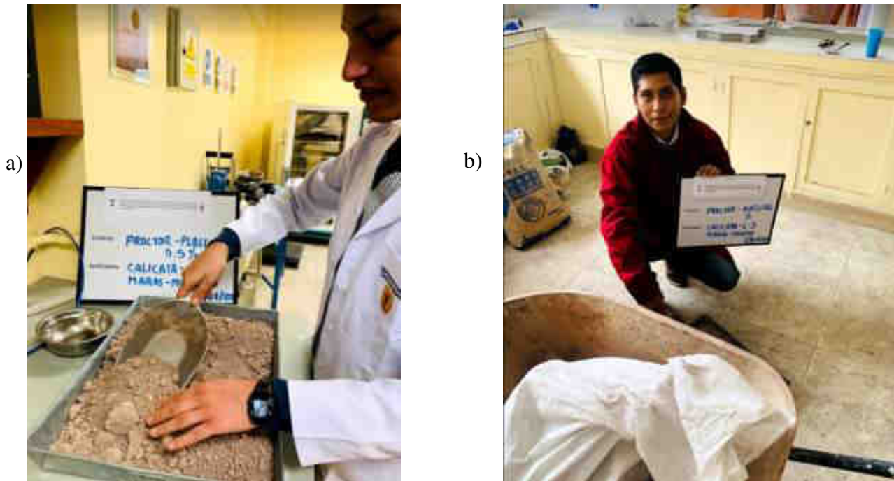
Figura 34:a) Dosificación del tereftalato al 0.5% y 1% “b)”, Dosificación del tereftalato al 1.5% y 2% ”
