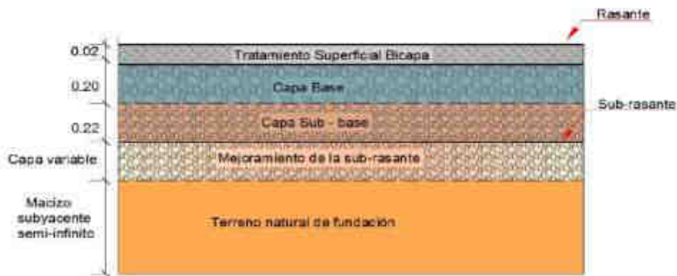
Figura 3: Sección transversal- Pavimento flexible
