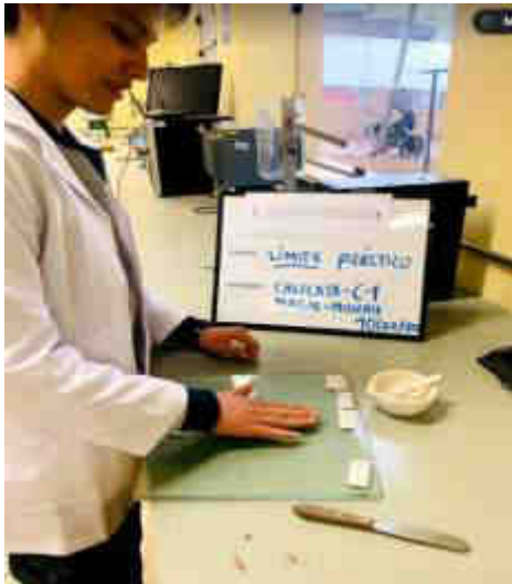
Figura 26: a) Amasado del suelo, b) Mezclado continuo sobre la placa de vidrio
