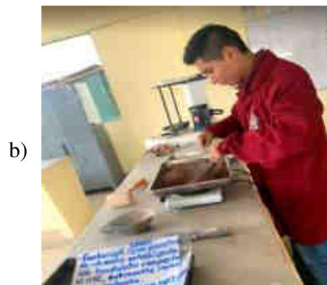
Figura 21: Secado del material “a)”, Ensayo de contenido de humedad “b)”
