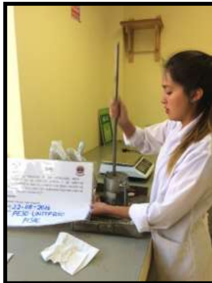
Figura 27: Compactado de la última capa de arena
