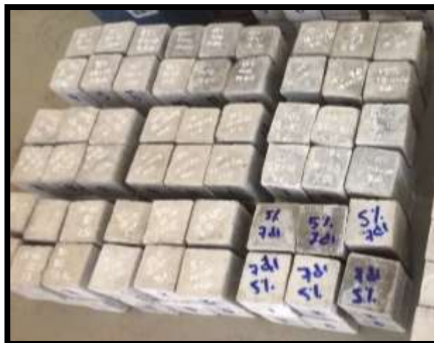
Figura 43: Desmoldado de especímenes cúbicos de mortero
