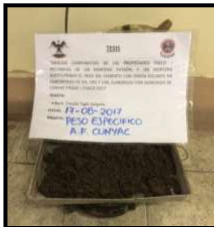
Figura 18: Secado del material saturado
