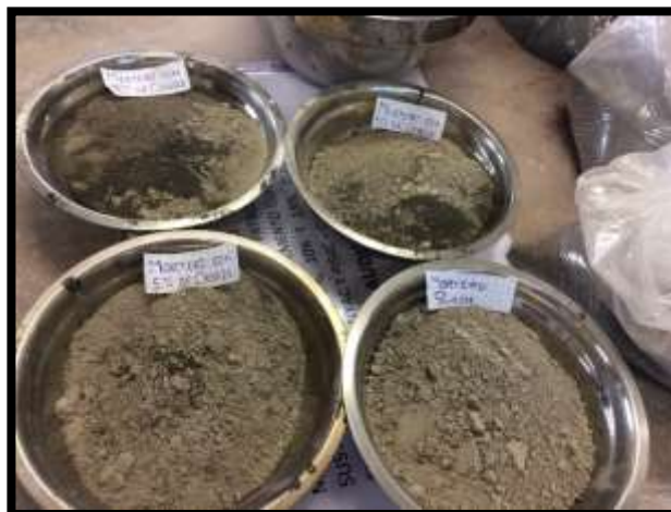
Figura 37: Preparación de la mezcla de mortero para el ensayo de consistencia
