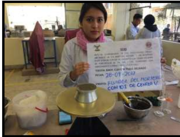
Figura 38: Molde cónico con las dos capas de mortero luego de ser compactado
