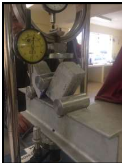
Figura 51: Falla de viguetas de mortero
