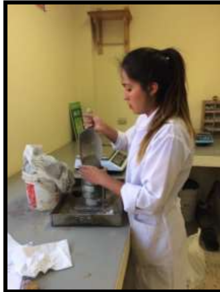
Figura 26: Colocado del agregado en el molde
