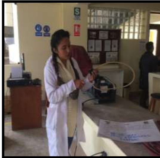
Figura 23: Eliminación de burbujas de aire con la bomba de vacíos
