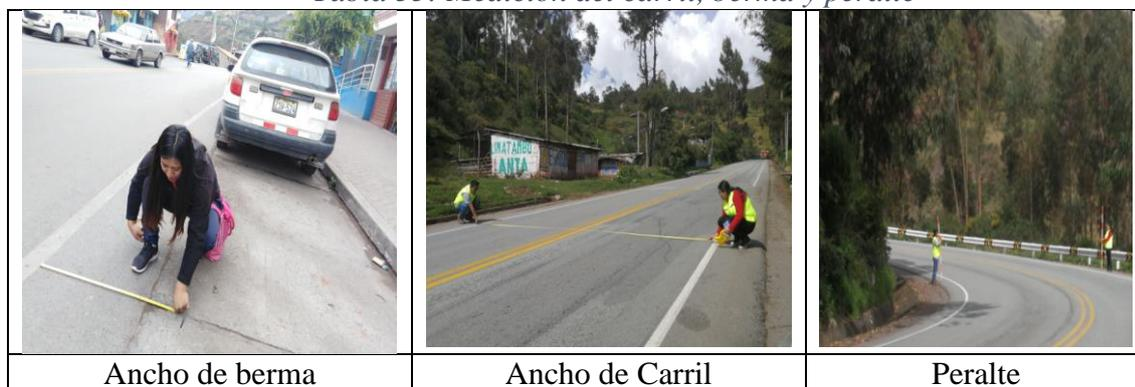
Luego los puntos obtenidos en el GPS sub métrico fueron exportados y procesados se realizó a través del software “AutoCAD Civil 3D v.18” para determinar las características de la vía
