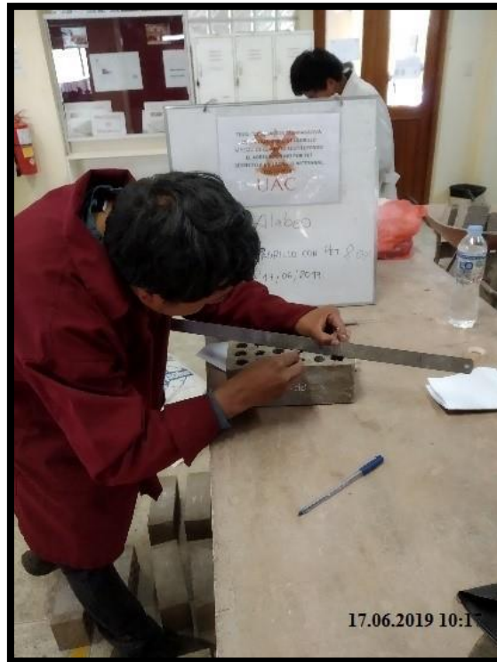
Figura 54. Toma de datos para los valores de alabeo en el laboratorio de la UAC.
