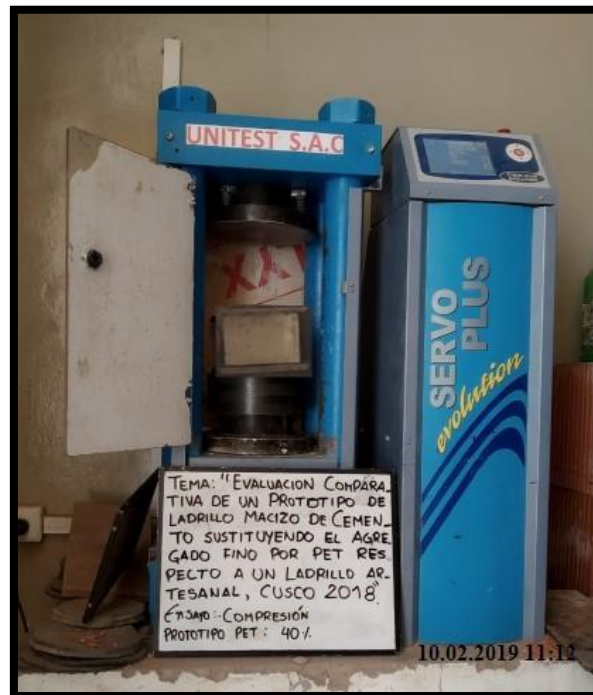
Figura 47. Máquina compresión universal con el prototipo de ladrillo
