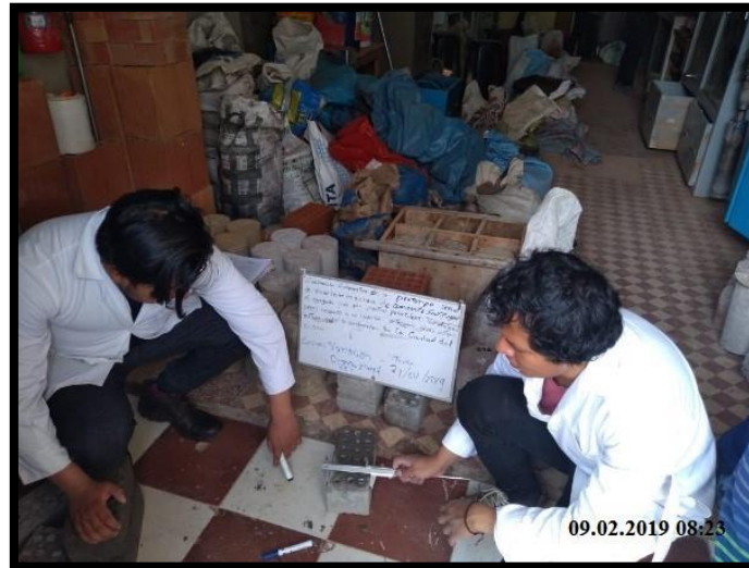
Figura 52. Medición para los valores de concavidad - convexidad en los prototipos de ladrillo.
