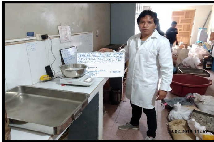
Figura 39. Pesaje del PET seleccionado para la determinación de su granulometría. Luego se realizó el tamizado manualmente utilizando los tamices ASTM.
