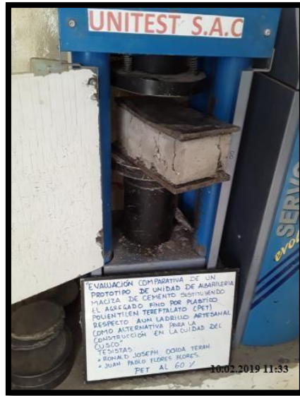
Figura 48. Prototipo de ladrillo posterior a la rotura
