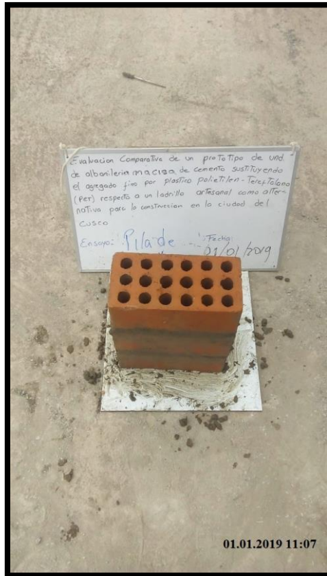
Figura 45. Pila de Ladrillo Artesanal
