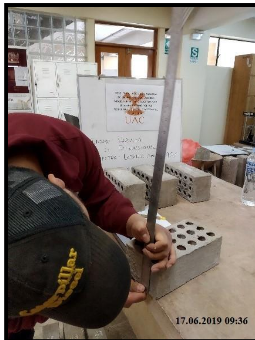
Figura 53. Toma de datos para variación dimensional en los prototipos de ladrillo en el laboratorio del a UAC.
