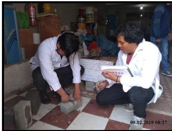
Figura 51. Toma de datos ancho en los prototipos de ladrillo.
