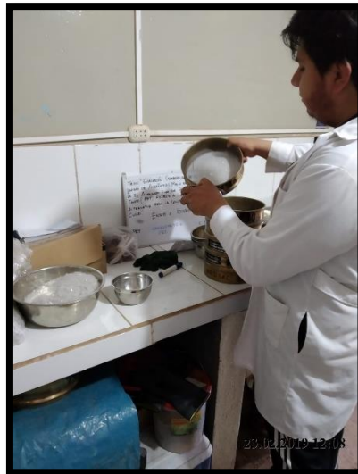
Figura 41. Revisión de los tamices después del zarandeo. Se realizó el pesaje de cada tamiz para que se pueda tener los pesos retenidos, y finalmente se observó la gradación del material de ensayo en este caso el PET, a su vez que se tomó los datos.
