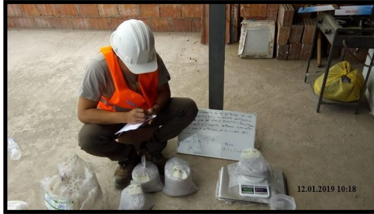
Figura 33. Separando las proporciones para las distintas dosificaciones empleadas. Posteriormente se hizo la preparación y mezcla del cemento con el agregado fino, así como las dosificaciones de PET.
