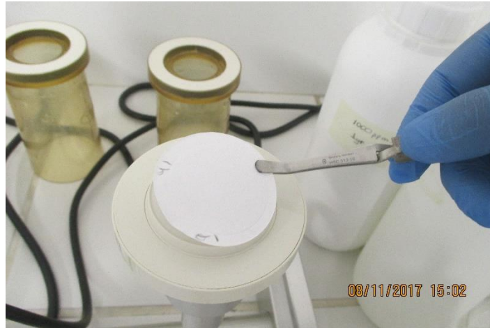
FIGURA N°69: FILTROS COLOCADOS SOBRE EL SOPORTE (EQUIPO DE FILTRACIÓN)
