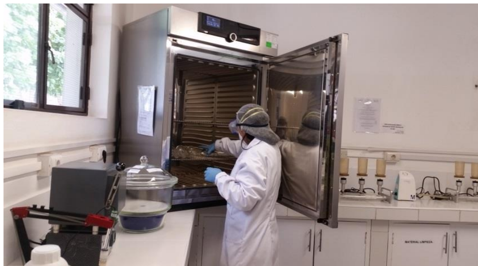
FIGURA N°72: COLOCACIÓN DE LAS CAPSULAS DE ALUMINIO JUNTO CON LOS FILTROS DENTRO DEL HORNO A 105°C
