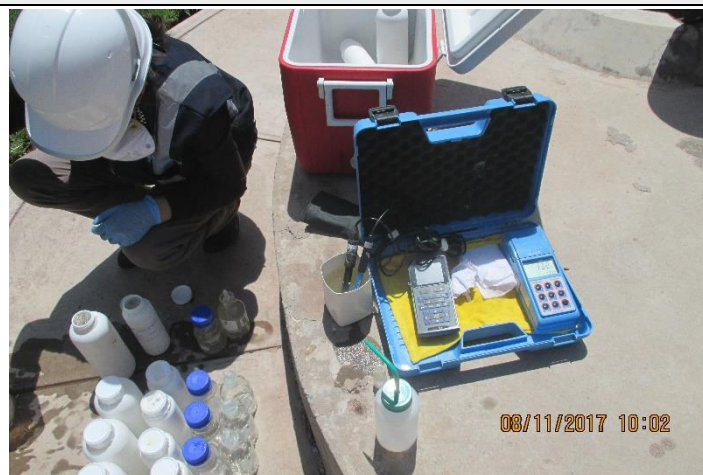
FIGURA N°68: RECOLECCIÓN DE MUESTRAS PARA STS
