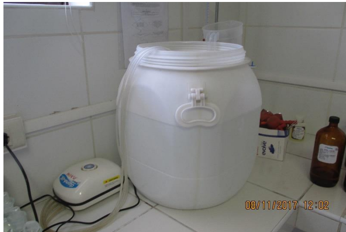
FIGURA N°56: GARRAFA CON AGUA DESTILADA AIREÁNDOSE
