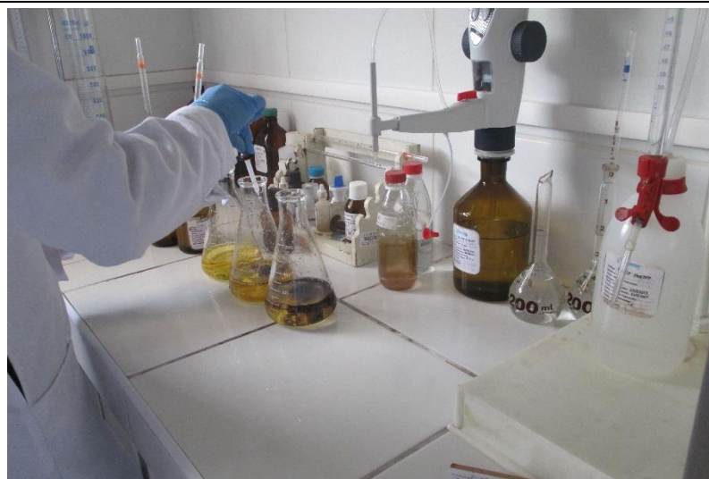
FIGURA N°67: LECTURA DEL OXIGENO DISUELTO FINAL
