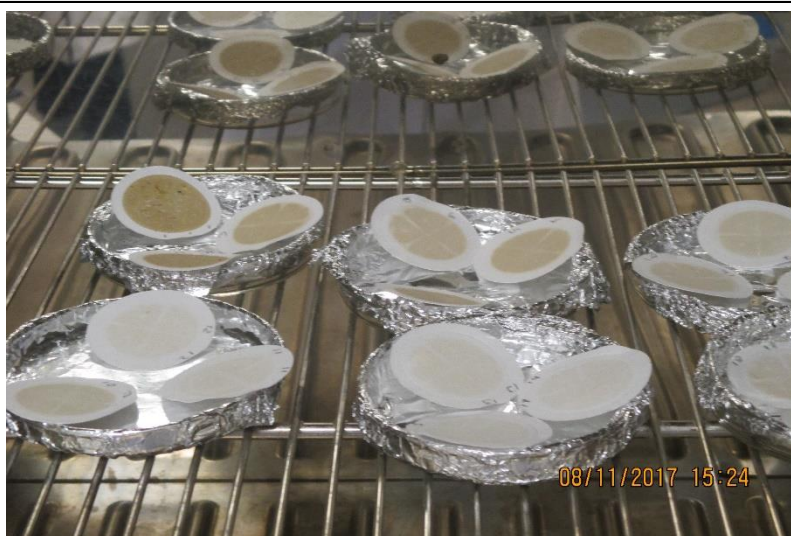
FIGURA N°75: CAPSULAS DE ALUMINIO JUNTO CON LOS FILTROS DESPUÉS DEL PROCESO DE FILTRACIÓN AL VACÍO
