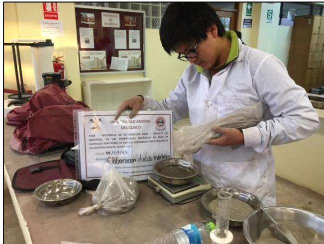
Figura 52 Elaboración de mortero 1:4 (cemento: agregado).
