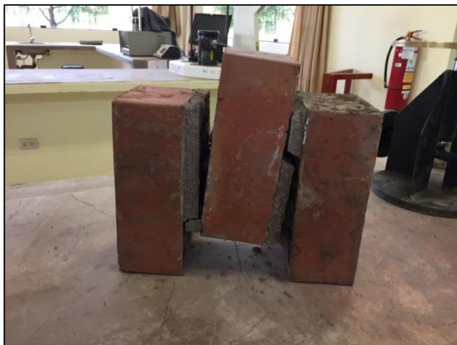
Figura 67 Rotura típica por corte en pilas.
