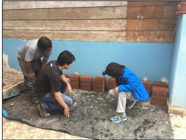
Figura 58 Verificación de dimensiones de la pila de albañilería.
