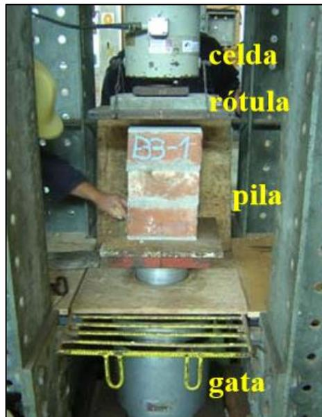
Figura 9 Ensayo de resistencia a la compresión axial en pilas.
