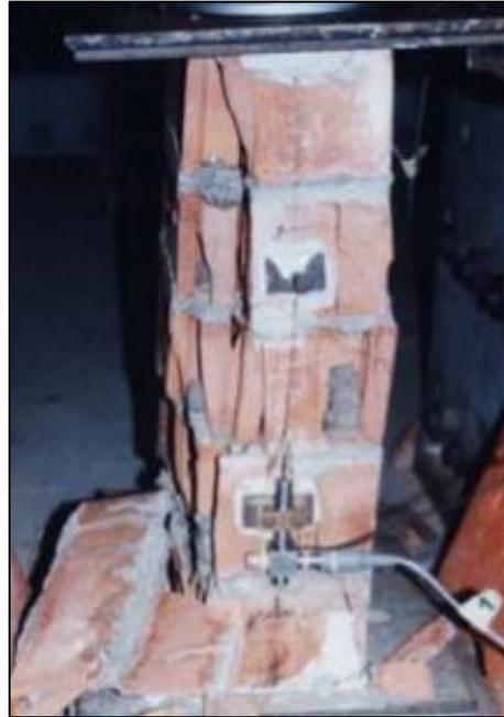
Figura 11 Falla indeseable en pilas.
