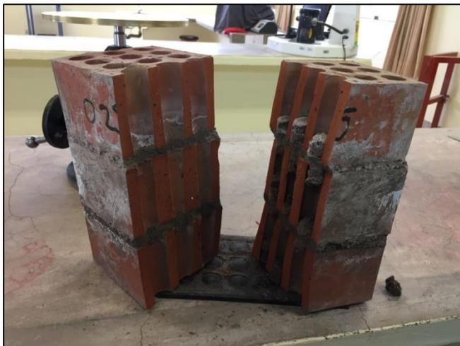
Figura 62 Falla de pilas de albañilería por fisuramiento.
