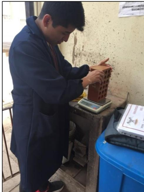
Figura 38 Peso de unidades luego de ser sumergidas 24 horas.
