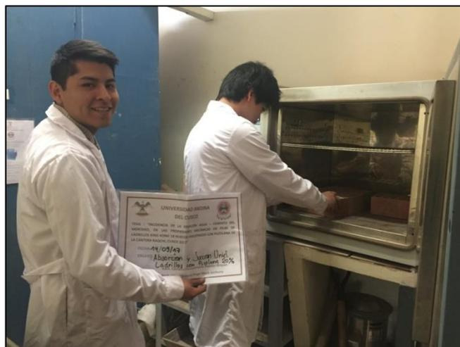
Figura 36 Colocado de unidades en el horno
