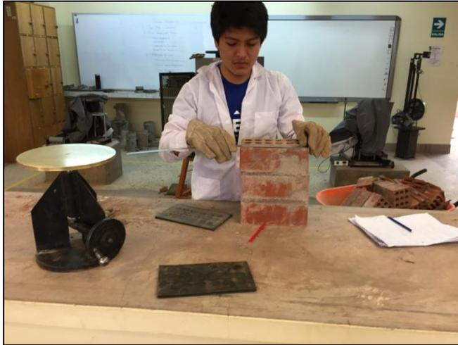
Figura 60 Medición de pilas de albañilería.
