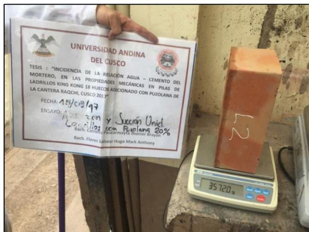
Figura 35 Control de peso de unidades después de succión.
