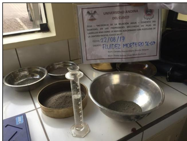
Figura 47 Preparación de mezcla de mortero para ensayo de fluidez.
