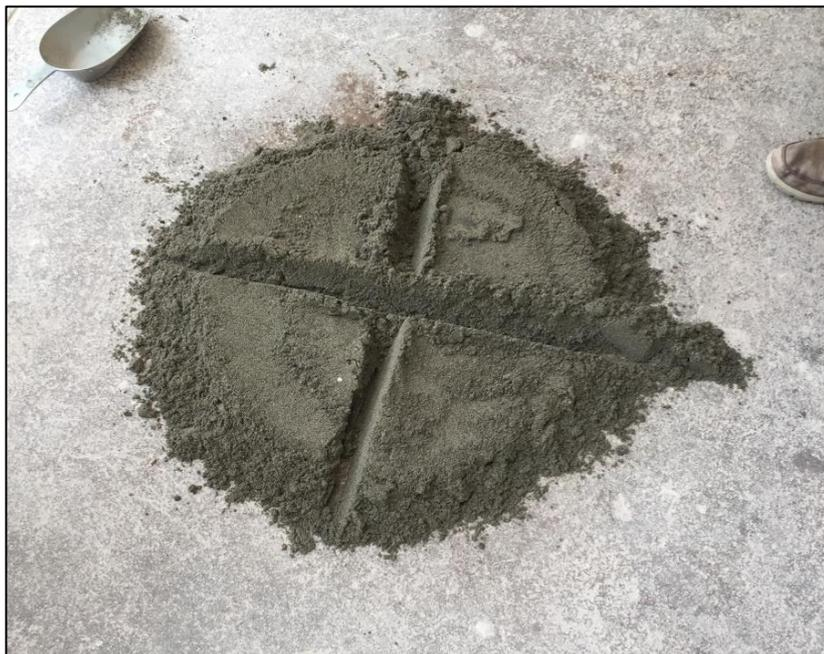
Figura 42 Cuarteo de agregado fino.
