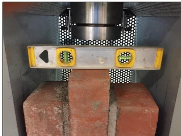
Figura 65 Verificación de nivel de la pila.
