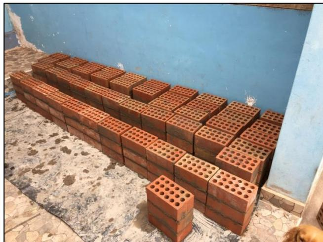
Figura 59 Almacenamiento y curado de pilas de albañilería.
