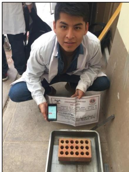
Figura 34 Ensayo de succión.
