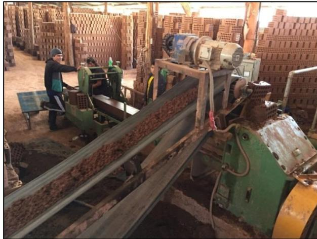
Figura 24 Alimentación de maquina extrusora (moldeado de ladrillos King Kong 18 huecos).
