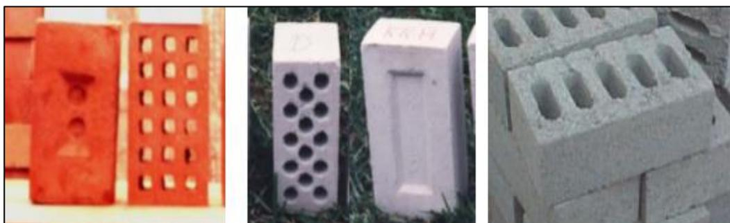
Figura 5 Ladrillos de arcilla (izquierda), sílice-cal (centro) y de concreto (derecha).
