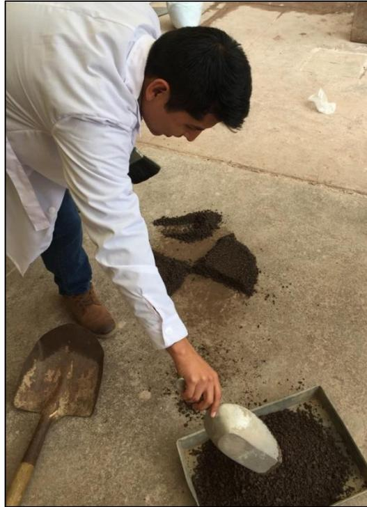
Figura 43 Eliminación de 2 partes de cuarteo de agregado.
