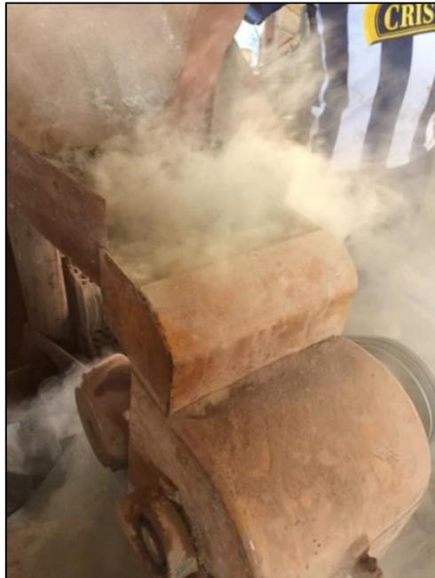
Figura 17 Triturador mecánico.
