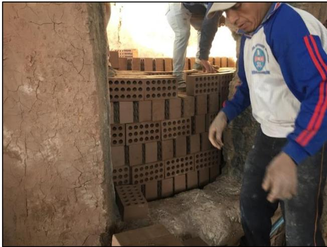
Figura 28 Colocado de unidades al horno.
