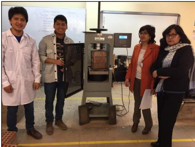
Figura 61 Compresión de pilas de albañilería.
