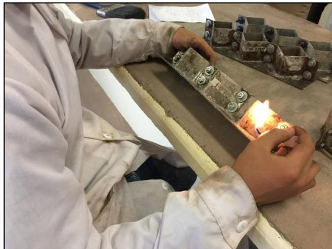
Figura 51 Sellado con parafina en moldes de mortero.
