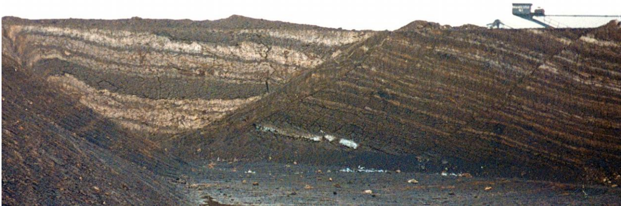
Abb. 51 Versatz der Flözbänke 5 und 6 (links) gegen die FBG 1 in Berzdorf (Foto: Bräutigam)
