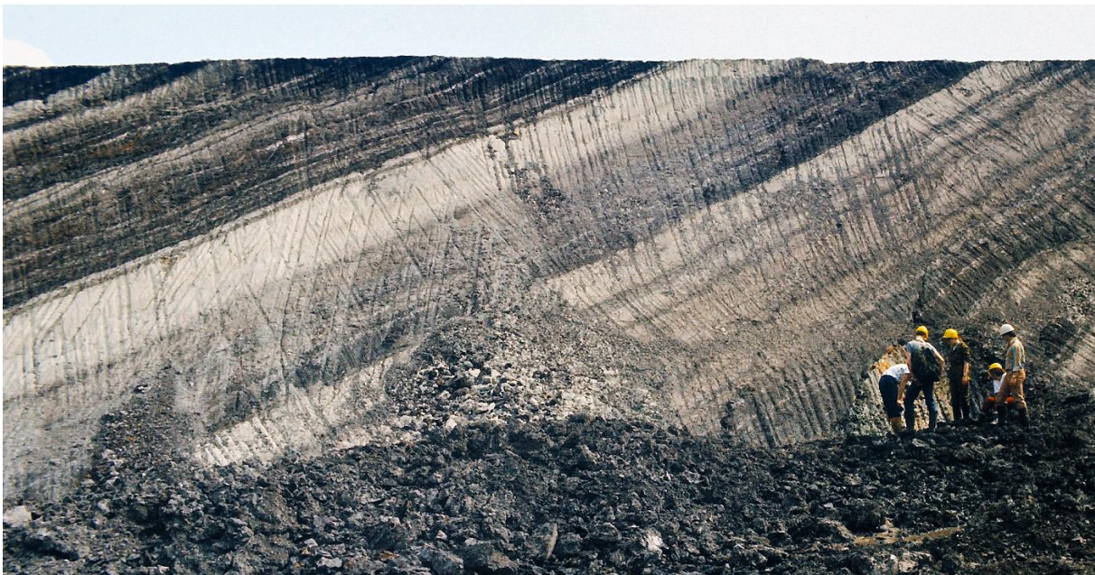
b) Detailaufnahme der Schrägstellung der Flözbänke FB-2 bis FB-8 (linke obere Bildecke) im nordöstlichen Zentralfeld von Berzdorf. Mächtiges helles Band: ZM 4. (Foto: Bräutigam, 1989)
