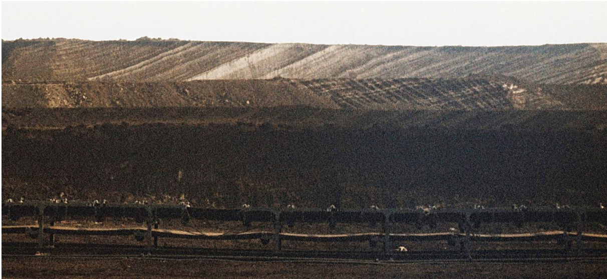
a) Übersichtsaufnahme der Schrägstellung des gesamten Kohlepakets ab FBG 1 (rechts) bis FB-8 (links) im nordöstlichen Zentralfeld von Berzdorf. Mächtiges helles Band: ZM 4. (Foto: Bräutigam, 1989)
