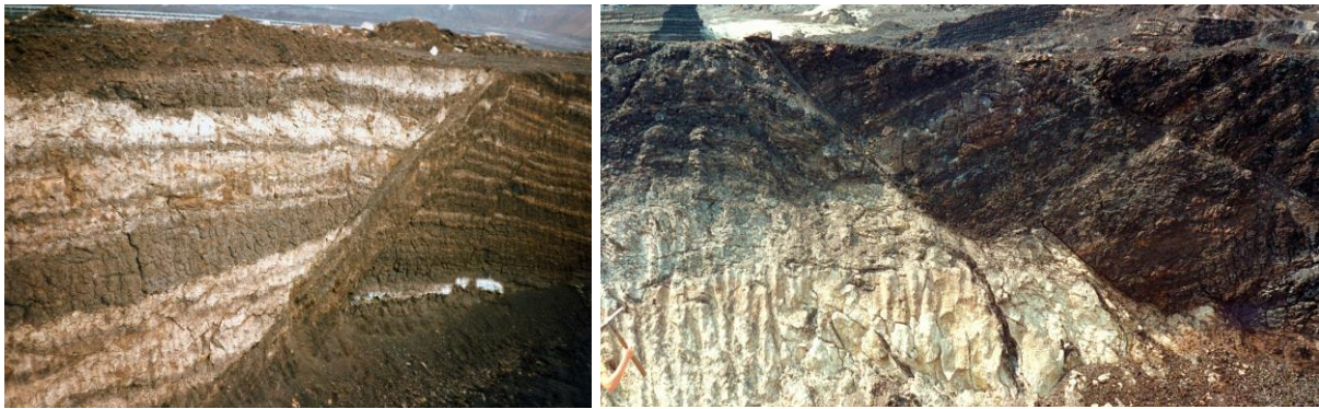
Abb. 10 Bruchtektonik im Tagebau Berzdorf (Fotos: Bräutigam, 1989). Foto links: Abschiebung der FB 4 + 5 von FBG 1, Foto rechts: staffelartige Abschiebungen der FBG 1 gegen kaolinisierten Granodiorit.
