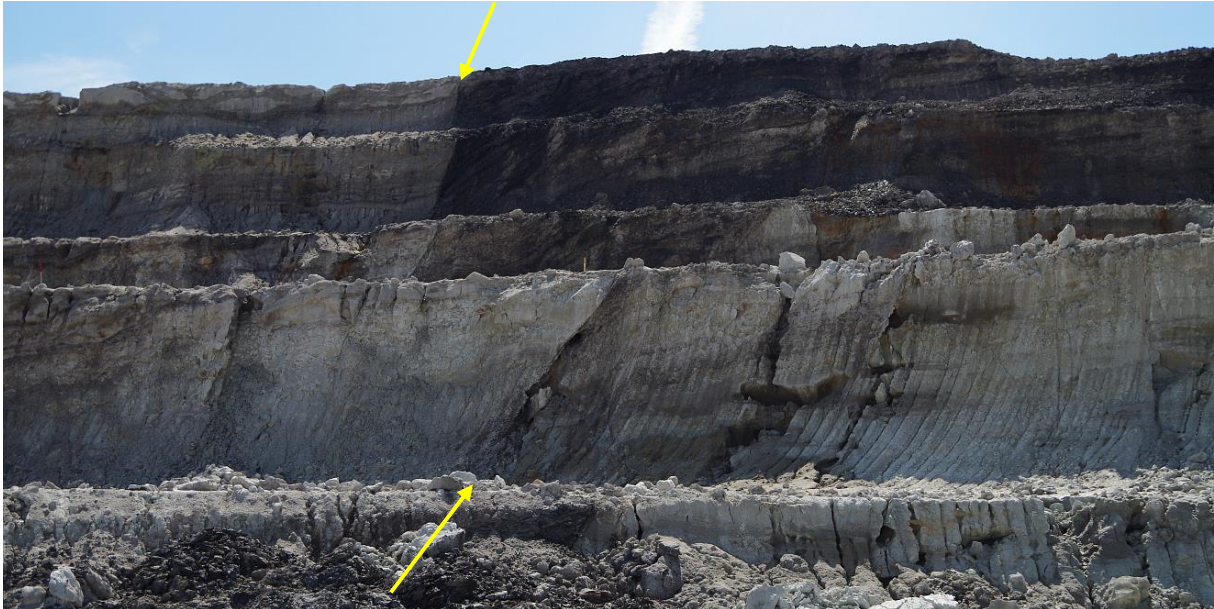
Abb. 57 Abschiebung der Schluffmulde in Turów von der Unterbank (pokład III) im Bereich der Zwischenstörung zwischen Zittauer Süd- und Nordsprung (Foto: Stanek, 2012)
