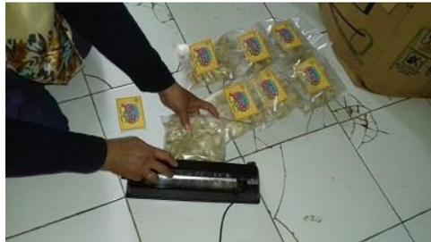
**Gambar 1.** Siomay yang dikemas dengan menggunakan hand sealer
