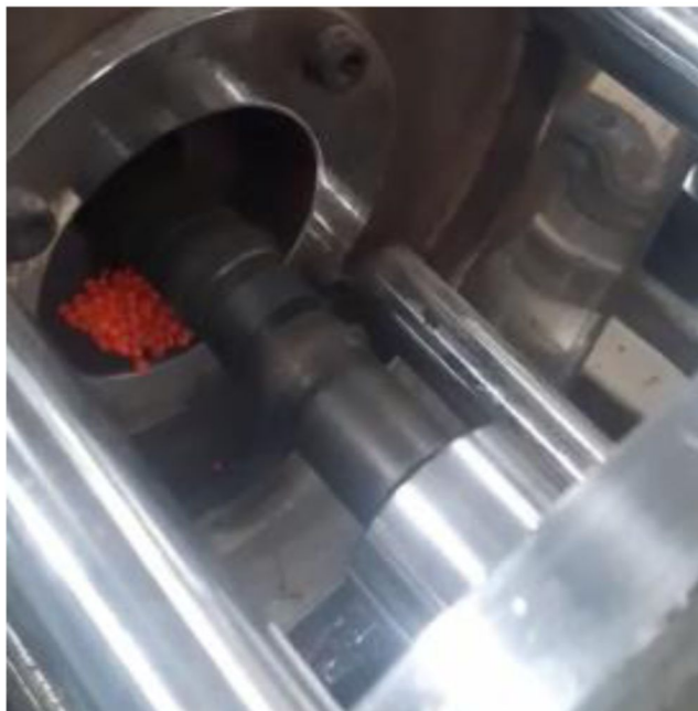
Gambar 4. As Cutting Dan Join Couple pada Mesin Extruder
