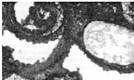
Figure 8.4 Micrographie d'une concrétion recouvrant un boulet de canon de l'épave du Batavia (1629). Les zones gris foncé sont constituées d'oxydes de fer alors que les zones gris clair contiennent du carbonate de fer FeCO_3 . Aucun carbonate de calcium n'a été détecté mais l'on distingue la structure des organismes marins. Les zones blanches sont vides, x300. (North, N.A. et MacLeod, I.D. 1987, p 69).
