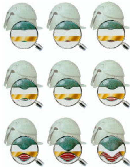
Figure 2.15 Mécanisme de formation des pustules de corrosion (Schiftpocken) (Born, H. 1993b, p 37).
