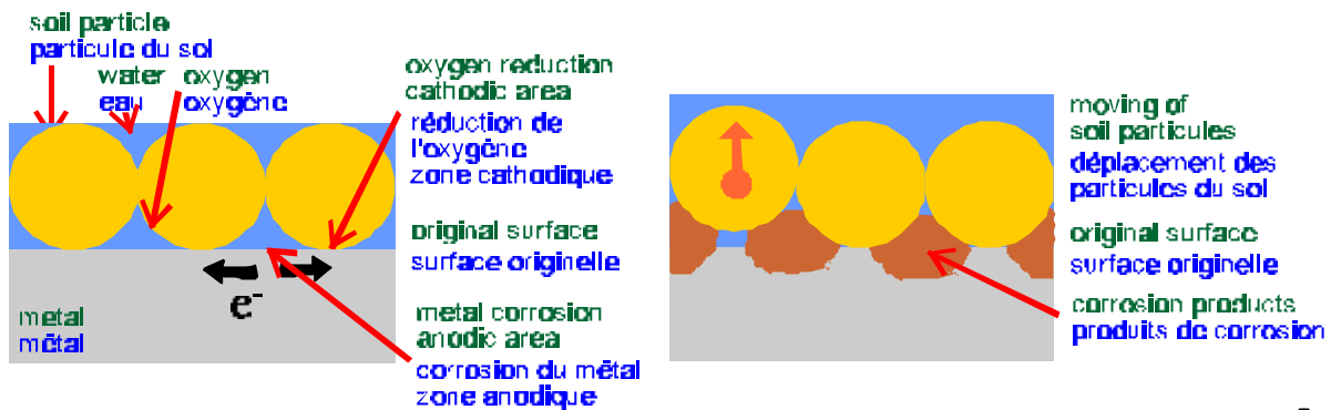
Figure 8.12 Déplacement des particules du sol dans un milieu poreux saturé d'eau lors du stade initial de la corrosion (dessin de l'auteur d'après T.Stambolov (Stambolov, T. 1985, p 32)).
