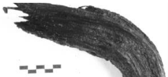
Figure 8.5 Extrémité d'un crochet en fer forgé provenant de l'épave de la Slava Rossi (XVIII e siècle) coulée en Méditerranée. La structure métallurgique fibreuse du fer forgé est révélée par la corrosion. L'interprétation du profil de la surface présente permet d'établir que celle-ci ne correspond pas à la surface d'origine (Photographie R.Bertholon.EDF-Valectra).
