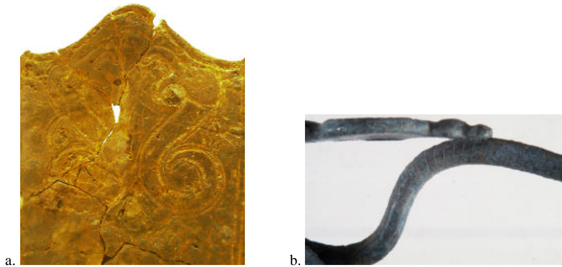
Figure 8.15 Profils remarquables. a. Profils remarquables des strates CP sur une entrée de fourreau en fer celtique interprétés comme un décor du type "lyre zoomorphe". Dans ce cas d'autres marqueurs peuvent être identifiés : porosité faible de la strate externe, présence de magnétite (largeur de l'image 4,5 cm, fourreau du site de Bucy-le-Long (France) en cours de nettoyage mécanique). b. rayures parallèles sous le pied d'une fibule en bronze interprétées comme des traces de fabrication (largeur de l'image 2 cm).
