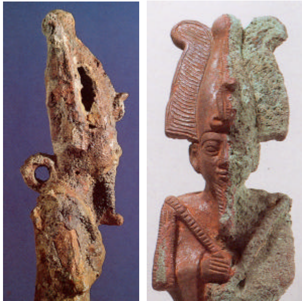
Figure 2.9 Deux statuettes d'Osiris en bronze. A gauche : statuette nettoyée à l'aide d'un bain d'acide. Les produits de corrosion ont été éliminés en grande partie révélant les irrégularités de la corrosion et conduisant à des lacunes où le métal était complètement corrodé. A droite : statuette nettoyée mécaniquement jusqu'à la surface d'origine à l'aide d'un burin de graveur électrique (Eichhorn, P. 1985, p 154 et 157).
