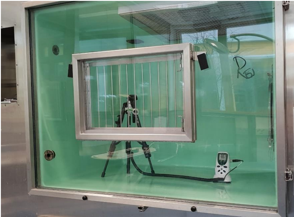
Figur 3. Extern syrgasmätare monterad på justerbart kamerastativ centralt i vänstra burhalvan av Syrgasbur 2's övre bur. (Foto: Linn Vennerholm, 2021)
