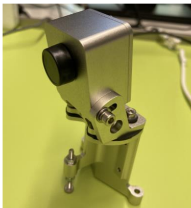
Figure 14: The OPT1 camera assembly EM
