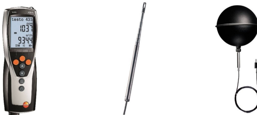
Слика 10 - Testo 435-1 логер (лево) 8 са пратећим сондама: анемометар \varnothing 7.5 mm (централно) 9 и глобус термометар \varnothing 150 mm, термопар тип К (десно) 10 .
