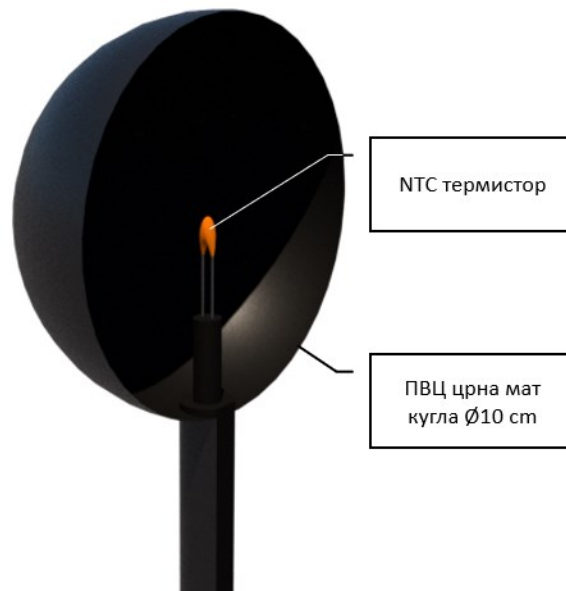
Слика 32 – Визуелни приказ конструкције црног глобус термометра.
