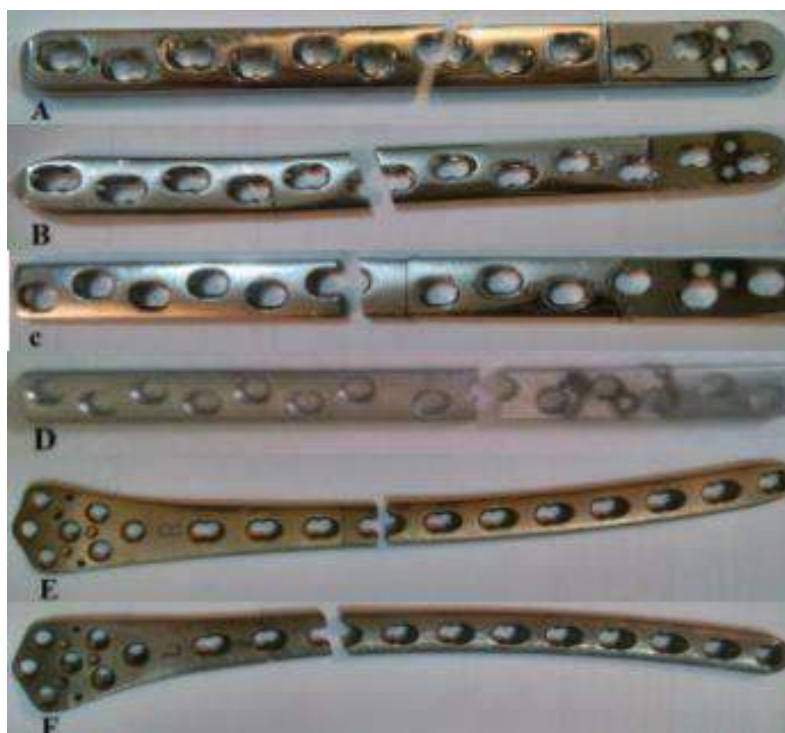
Slika 3.7 Tipičan izgled loma LCP pločica usled zamora [85]
