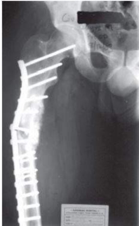
Slika 1.2 Primer polomljene pločice za fiksaciju preloma [3].
