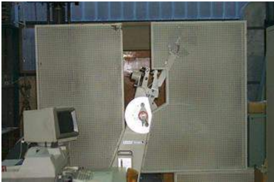
Slika 4.10 Instrumentirano Šarpi klatno 150/300J
