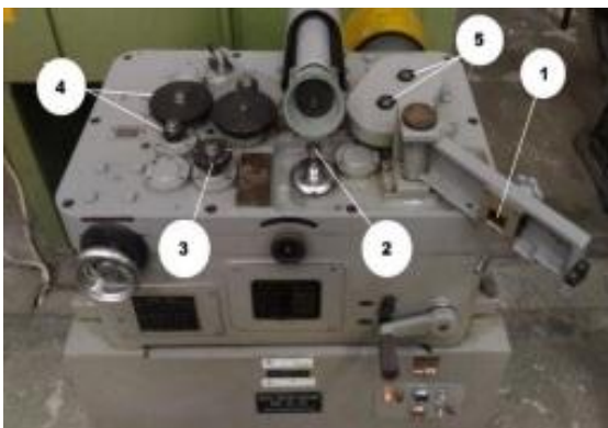
GAMBAR 9. Mesin uji keausan Ogoshi (TekniMesin, UGM)
