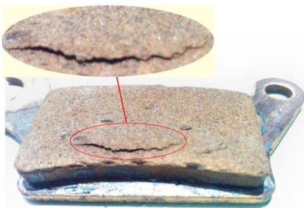
GAMBAR 13. Retakan pada kampas serbuk kayu jati (SKJ) 170°
