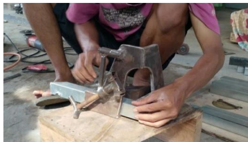
Gambar 3.1. Proses set up menggunakan alat bantu
