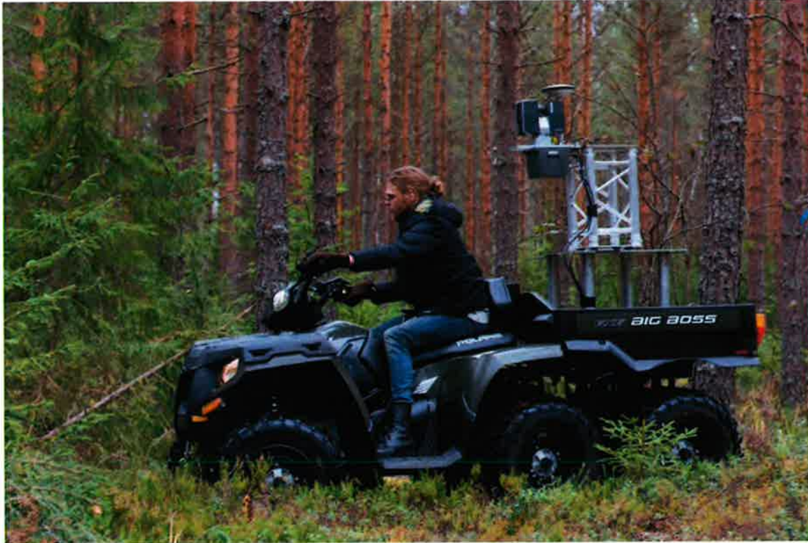
Kuva 3. Puuston MLS-mittaus voidaan tehdä esimerkiksi mönkijään asennetulla keilaimella tai reppukeilaimella. (Holopainen ym. 2015)
