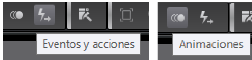
Ilustración 110. Botones de acceso directo a los eventos y acciones, y a las animaciones en Sysmac Studio.
