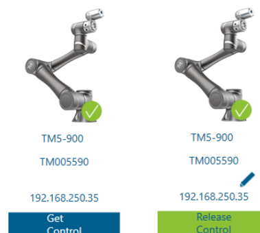
Ilustración 141. Conectarse al cobot por medio de Ethernet en TMflow.
