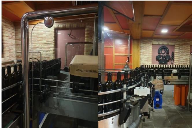
*Ilustración 3. Mesa de acumulación y cinta transportadora, Stratus*
