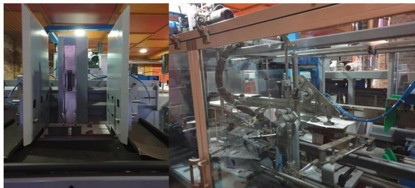
*Ilustración 9. Formadora de cajas, Stratus*
