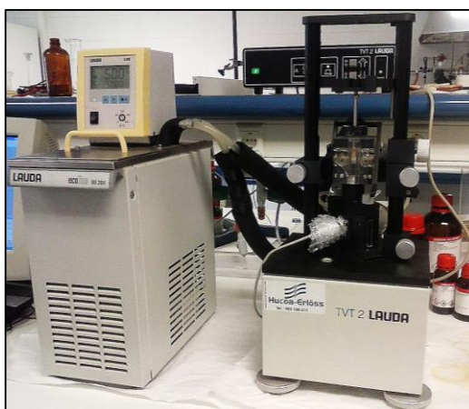
Figura 7.52. Tensiómetro Lauda TVT-2 utilizado para medir la tensión superficial.
