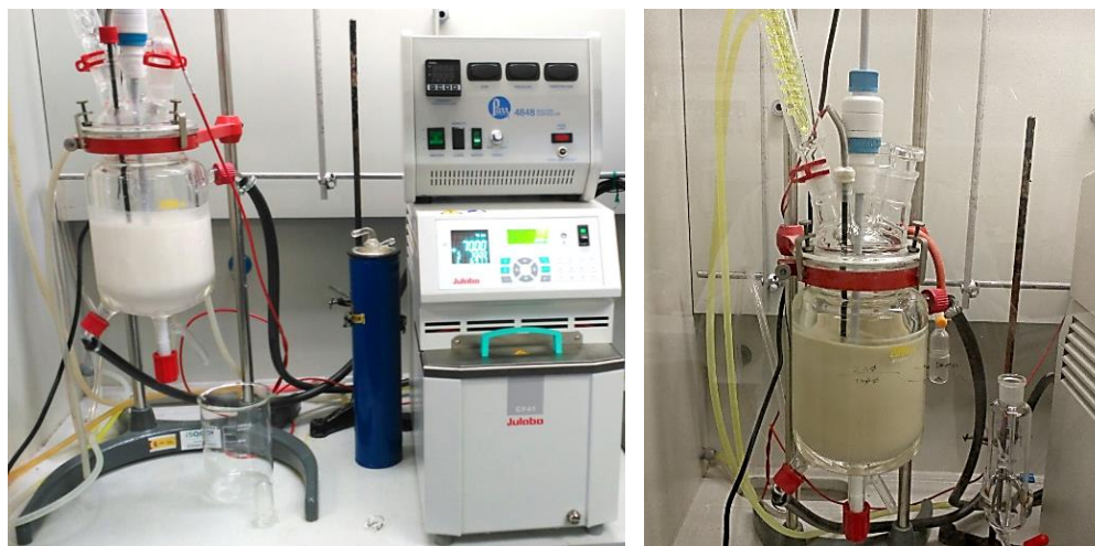
Figura 2.49. Reactor utilizado en el escalado de la síntesis de los diéters. A la izquierda se observa el precipitado blanco del KCl (método I) y a la derecha la arcilla K10-H + (método II tándem).
