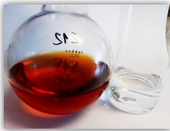
Figura 2.50. Crudo de la síntesis de un triéter de glicerol antes y después del lavado con tiosulfato.
