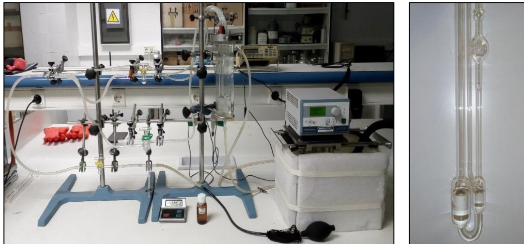
Figura 7.51. Montaje experimental para la determinación de la viscosidad y detalle del viscosímetro.
