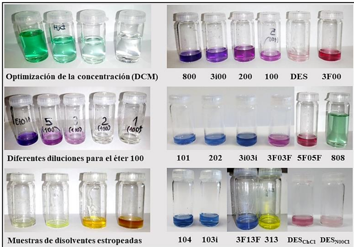
Figura 4.17. Colores de la Betaína de Reichardt en diferentes disolventes derivados de glicerol.
