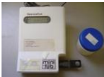
Figura 10. Spermacue®. Espectrofotómetro utilizado para recuento celular. Resultado = n^{\circ} \times 10^6 spmtz/ml.
