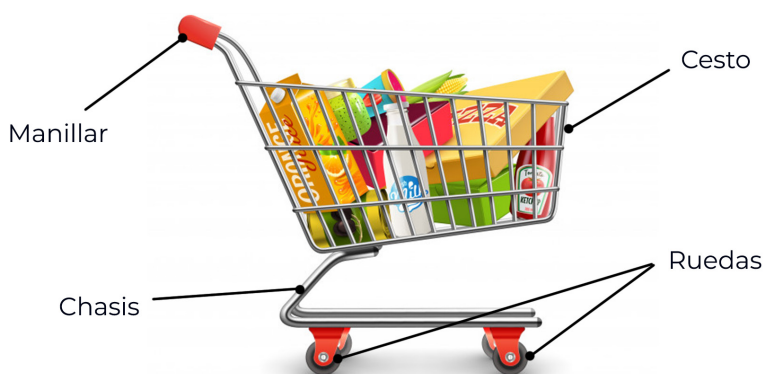
Figura 1.4 | Esquema de componentes de un carro [F3]
