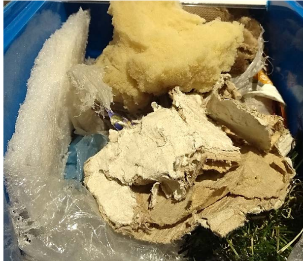
Imagen 11: Plásticos trapos y cuerdas rechazados la fuerza centrípeta
