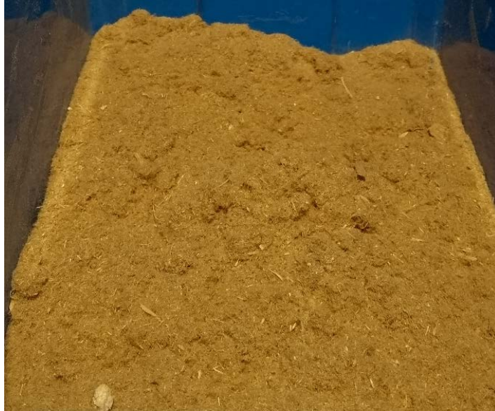
Imagen 23: Polvo de las aspiraciones en filtros de mangas
