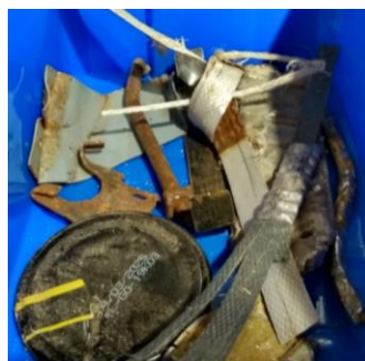
(Anexo de fotografías del proceso de fabricación: Imagen 10: Metales expulsados en los tambores magnéticos)
