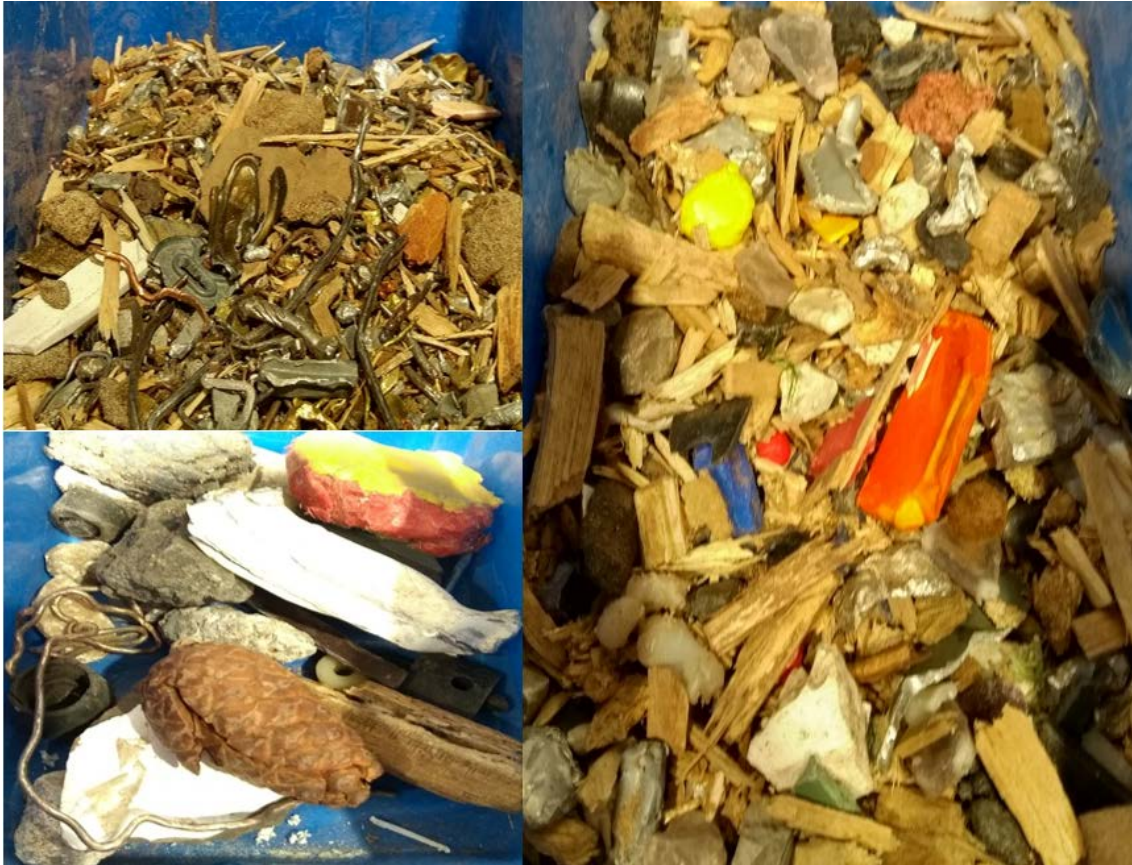
Imagen 14: Rechazo de material pesado
