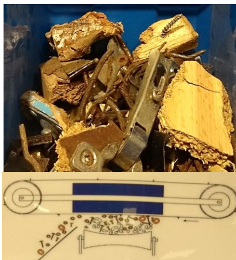
(Anexo de fotografías del proceso de fabricación: Imagen 9: Metales que atrapan las cintas de imán)
