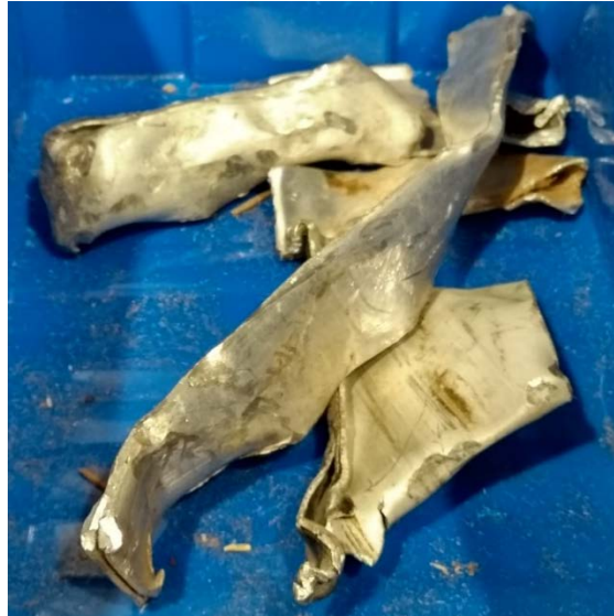
Imagen 16: Metales no ferrosos eliminados por inductivos
