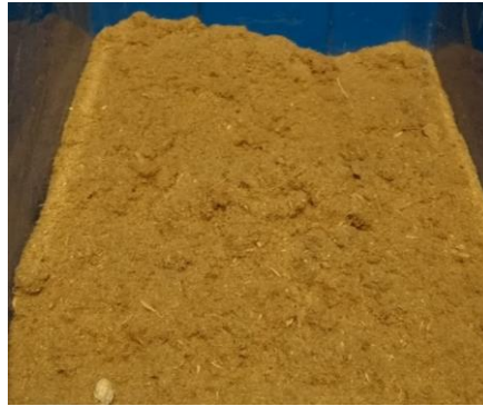
(Anexo de fotografías del proceso de fabricación: Imagen 23: Polvo de las aspiraciones en filtros de mangas)
