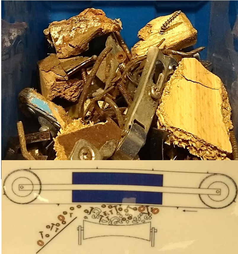
Imagen 9: Metales que atrapan las cintas de imán
