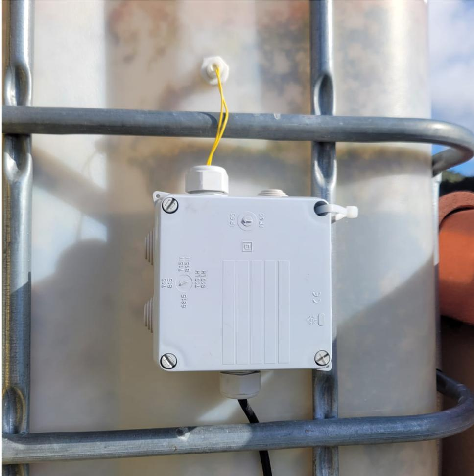
*Figura 64. Montaje del sensor en uno de los bidones*
