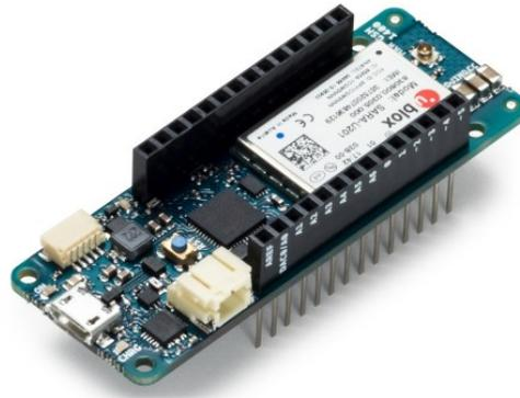
*Figura 34. Arduino MKR GSM 1400*
