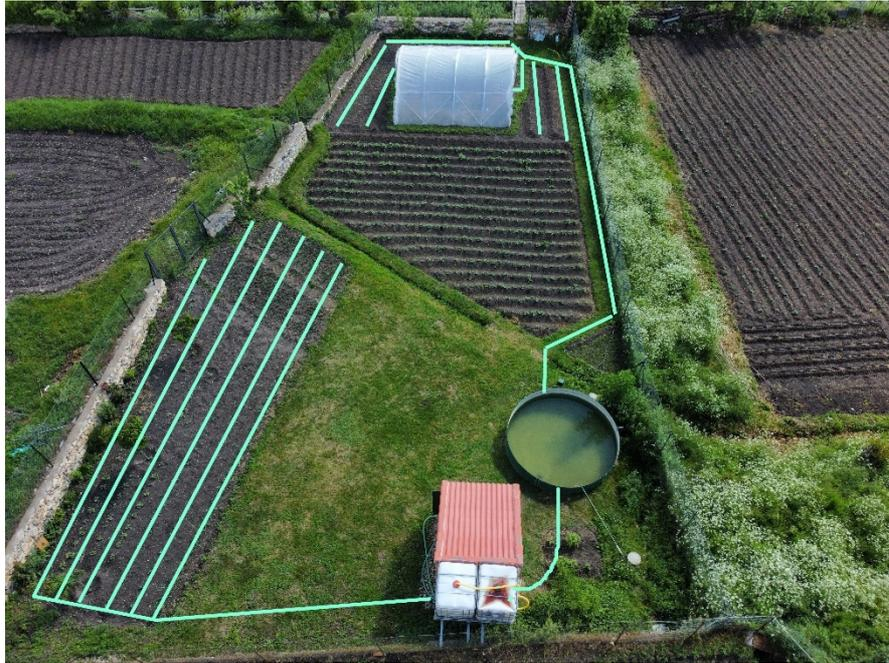
*Figura 3. División del huerto en dos circuitos de riego*
