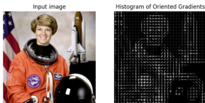
Figura 2.2: Resultado de la aplicación del descriptor de HOG a una imagen. Figura obtenida de [2]
