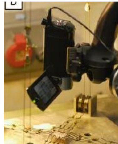
Figuras 5, 6, 7 y 8. Ensayo de tracción biaxial sobre una muestra de tejido colónico porcino. Se puede apreciar con detalle como los rastrillos traccionan la probeta y como las agujas se posicionan en esta. En la tercera imagen se puede ver la nube de puntos negros esparcida sobre la muestra para posteriormente ser capturada y procesada por un sistema de imagen Dic como se ve en la cuarta figura.
