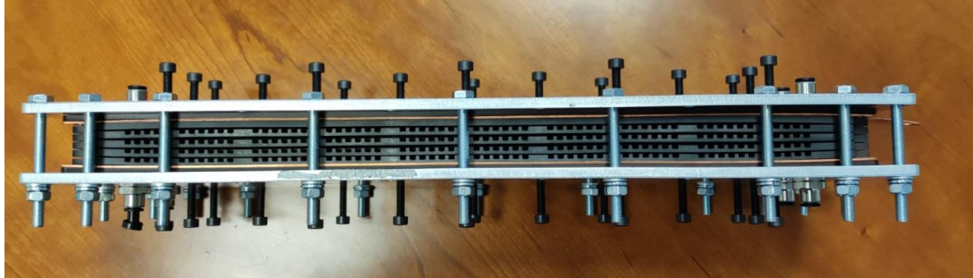
Figura 4 Pila de combustible PEM de cátodo abierto del LIFTEC
