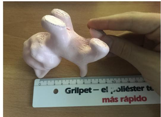
Figura 4.6: Medida tomada para establecer diferencias de escalas entre el objeto virtual (usado para entrenar la red) y el objeto impreso. A la izquierda, medida de la distancia en metros sobre la malla 3D del gato. A la derecha, medida de la distancia sobre el objeto impreso en 3D con una regla.
