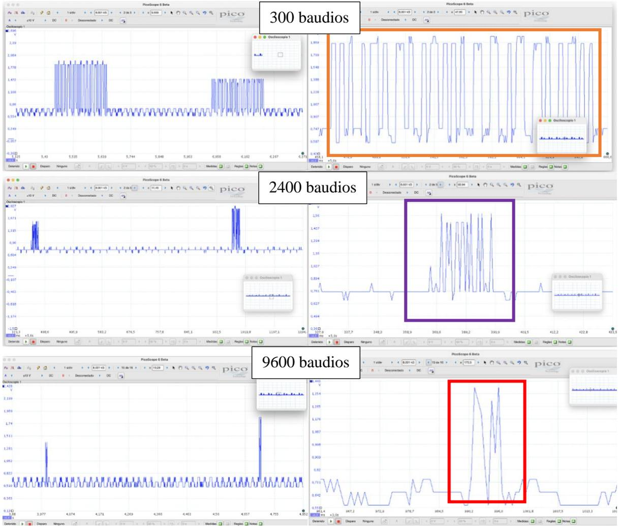
Ilustración 26. Señal recibida del fotodetector amplificada a distintas velocidades con distancia de 31cm.
